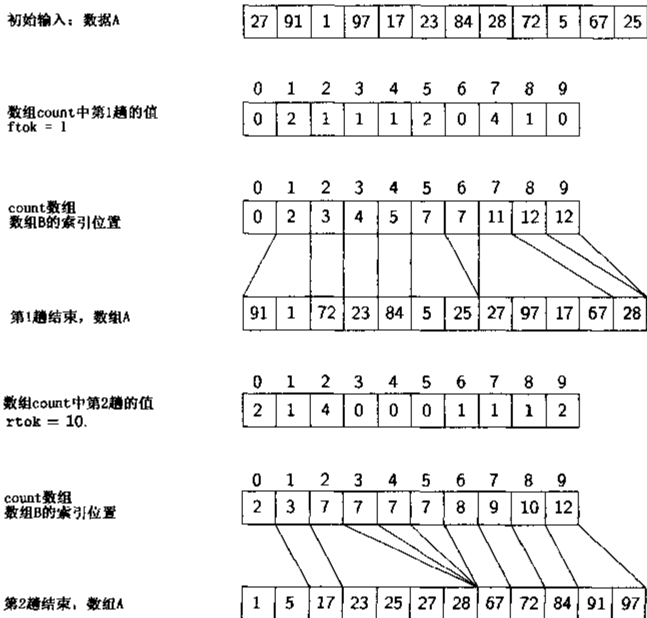
图 8.13 对于图 8.12 中的输入, 函数 radix 的运行示例。第一行显示输入数组中的初始数据。第二行是数组 count 计算每个盒子中记录数之后的值。第三行是存于数组 count 中的下标值。例如, count[0] 为 0, 表示第 0 个盒子中没有记录; count[1] 为 2, 表示数组 B 的第 0 个和第 1 个位置将存放第 1 个盒子中的记录; count[2] 为 3, 表示数组 B 的第 2 个位置将存放第 2 个盒子中的记录(仅有一个); count[7] 为 11, 表示数组 B 的第 7 个到第 10 个位置将存放第 7 个盒子的 4 个记录。第四行显示第一趟基数排序后的结果。第五至第七行展示了第二趟基数排序的类似步骤
