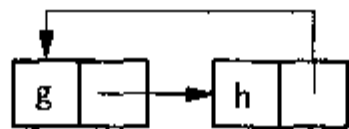
图 12.19 无用单元循环引用的例子。循环中的所有存储单元都有非 0 引用计数,因为每个单元都有一个指针指向它,但是整体上却是无用单元
