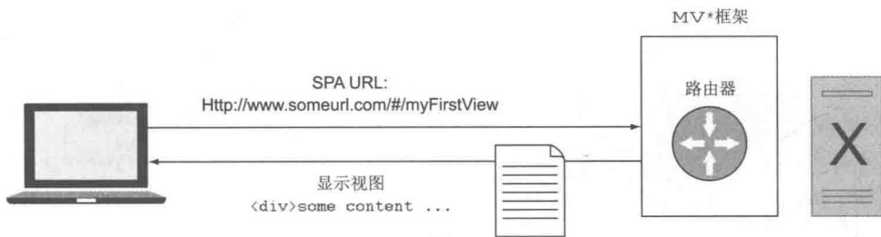
图 4.2 SPA 应用的客户端路由器负责导航控制，允许 SPA 显示新视图而非整个页面
