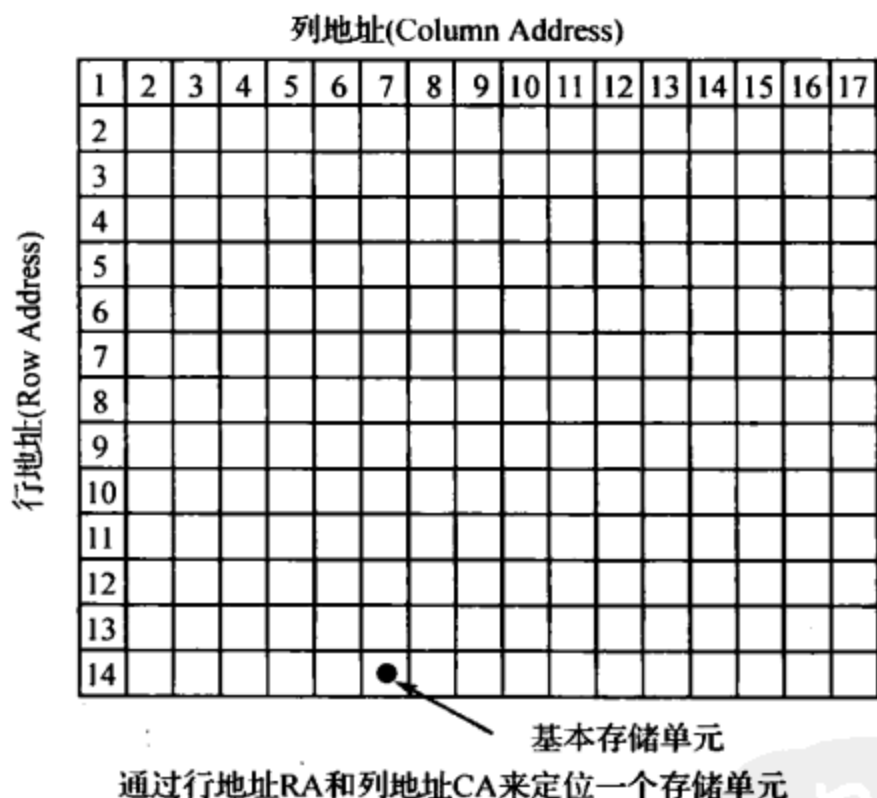
图 2-49 内存行、列地址寻址示意图
