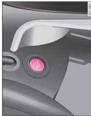
图 108 启动按钮位于转向柱右侧
