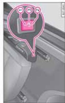
图 71 前排座椅下方的座椅通风开关
