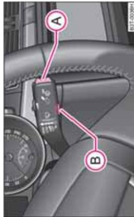
图 5 风窗玻璃刮水器控制杆上的按钮操作
