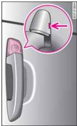
图 36 驾驶员车门应急解锁和闭锁
