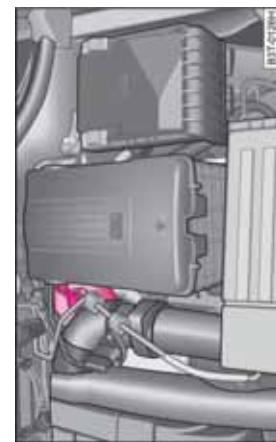
图 186 制动液液面位置
