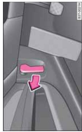
图 182 发动机舱盖解锁拉手
