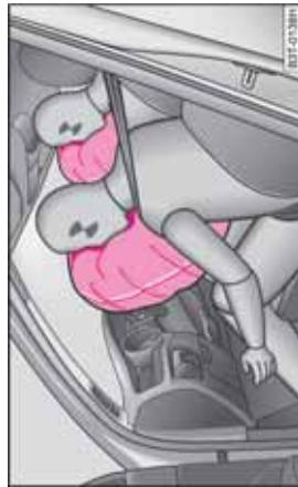
图 160 完全展开的安全气囊
