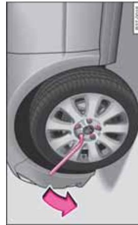
图 199 升起车辆前请拧松车轮螺栓
