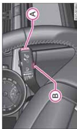
图 15 风窗玻璃刮水器拨杆按钮操作
