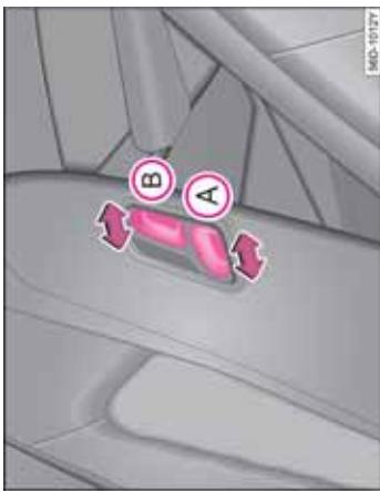
图 70 副驾驶员靠背上部的电动座椅调节装置
