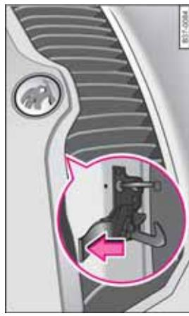
图 183 打开发动机舱盖
