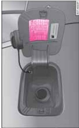
图 191 已打开的油箱盖板，上面标有轮胎充气压力数据。
