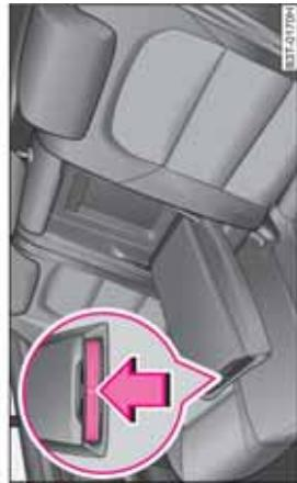
图 83 后座扶手手中的饮料杯支架开启
