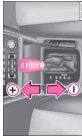
图 114 通过“Tiptronic”装置换档
