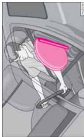
图 162 已充气的侧面安全气囊
