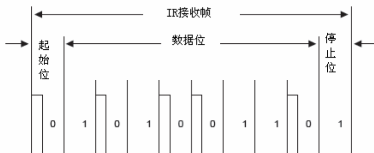
(c) 红外线接收模式下时序图
