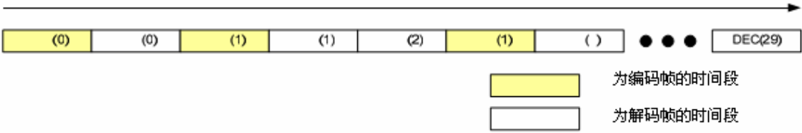
图 21-8 全双工通信编解码器进程
