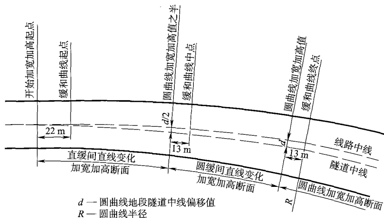
图 15.2.2 改建曲线地段隧道加宽加高示意图
