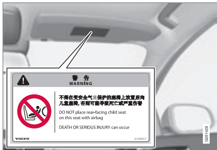
位置 1：安全气囊标签在乘客侧遮阳板处的位置。
