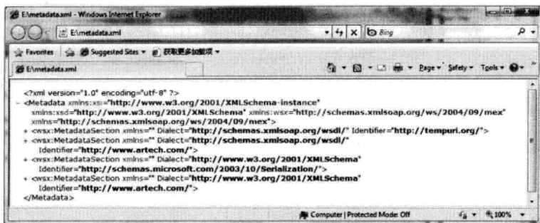
图 2-9 通过 IE 显示获取的元数据（以 WS-MEX 方式发布）
