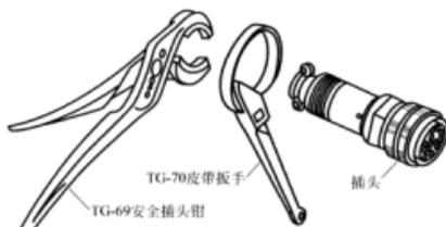
图 9-62 拆装插头的工具
