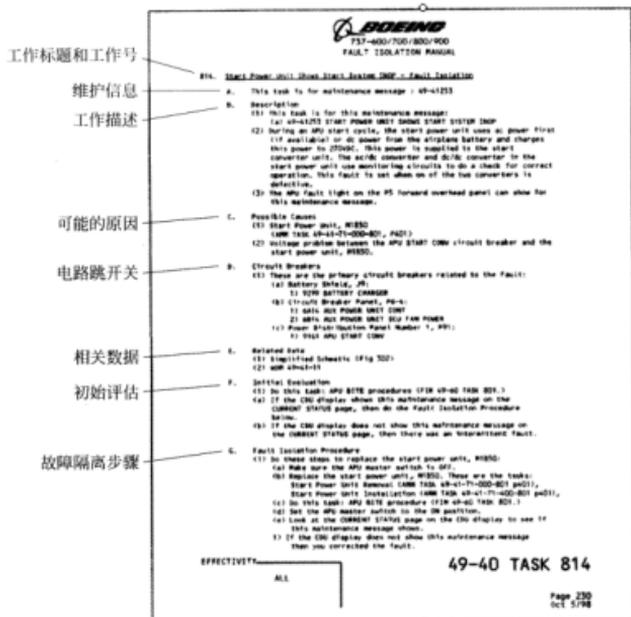
图 2-71 故障隔离程序结构
