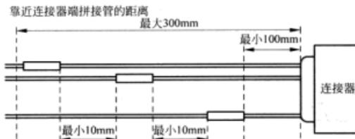
图 6-299 连接器端拼接管安装规范
