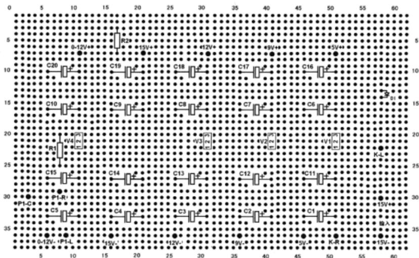
图 7-45 电源组件多孔板正面元件安装图
