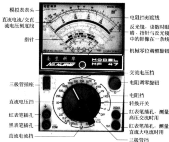
图 4-1 常用模拟式万用表结构和各部分功能
