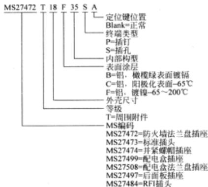
图 6-470 MS27472 系列连接器号结构
