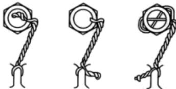
图 9-52 对空心堵头打保险(必须将保险丝末端弯向孔内,防止干涉和伤害在发动机上工作的人员)
