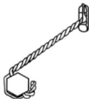
图 9-51 在不同平面上锁定螺栓(可以从任何一个螺栓开始打保险,但只能按锁紧螺栓的方向)
