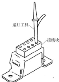
图 6-585 插钉拆除操作
