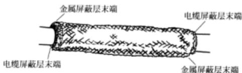
图 6-275 电缆屏蔽层与屏蔽材料位置
