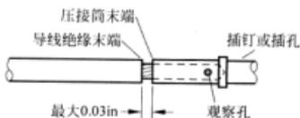
图 6-476 不带绝缘支撑筒的绝缘去除长度
