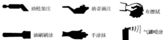
图 15-2 润滑方框图(空客手册样式)
