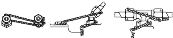
图 9-56 对不同标准的接头打保险的正确方法(检查螺帽用保险丝单独保险,这样当接头螺帽被拆下后,就没有必要拆下它)
