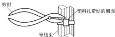
图 6-118 捆扎结去除工具的替代方法
