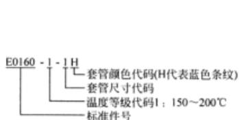
图 6-319 E0160 焊锡套管件号描述
