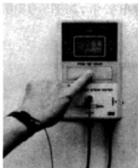
图 5-9 防静电手腕带测试仪
