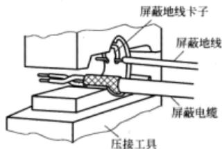
图 6-332 屏蔽地线制作压接
