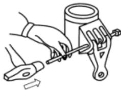
图 9-20 用冲子冲螺栓
