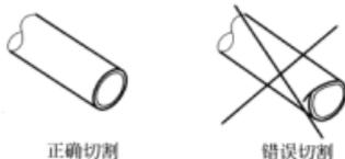
图 6-204 热缩管的正确切割
