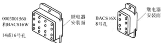
图 6-624 BACS16W 和 BACS16X 前退继电器座外形
