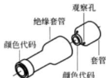
图 6-373 NSA937503 和 NSA937505 压接套管结构
