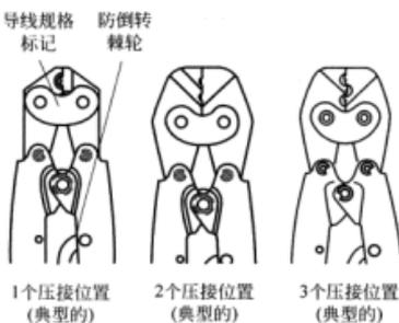
图 6-237 长柄压接工具介绍
