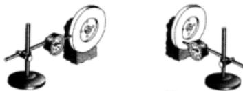
图 3-42 测椭圆度和端面跳动量
