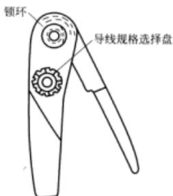
图 6-472 M22520/2-01 压接工具介绍
