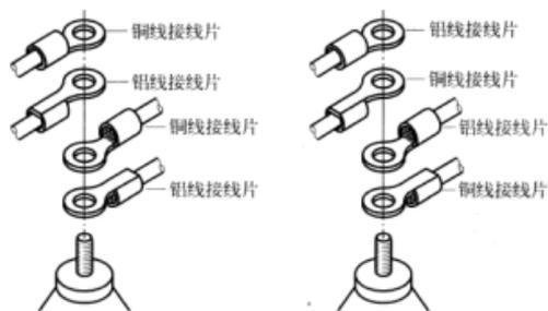
图 6-443 两个铝导线接线片与两个铜导线接线片在接地桩上安装
