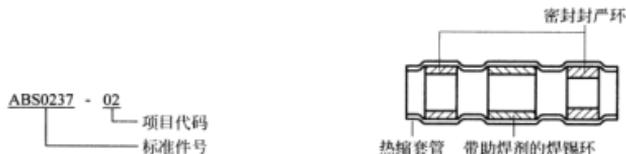
图 6-317 ABS0237 焊锡套管件号描述
