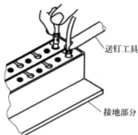
图 6-579 接地接线块插钉的安装
