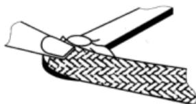
图 7-40 吸锡铜网编织带拆焊法
