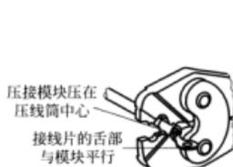
图 6-385 长柄压接工具使用
