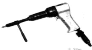
图 9-22 振动螺丝刀
