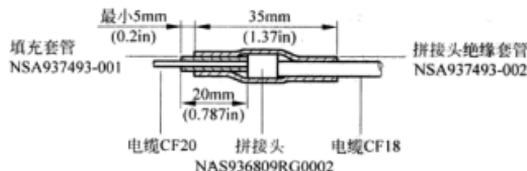
图 6-306 NSA936809 RG 系列拼接管热缩尺寸
