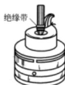
图 6-138 插头尾部安装防磨保护视图
