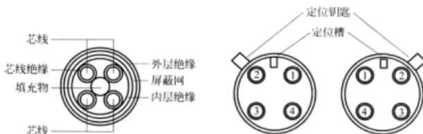
图 6-563 四芯电缆构型和四芯插头/座构型
