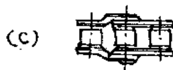
套筒滚子链的接头型式
