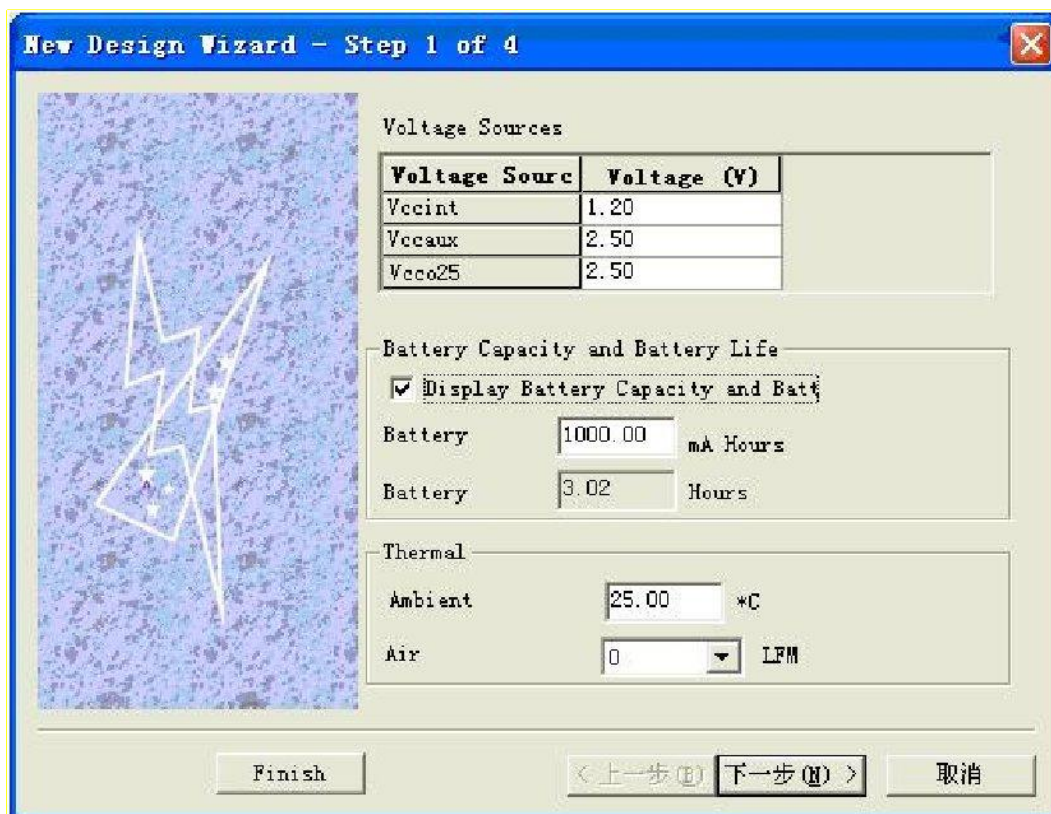
图 4-58 XPower 向导第 1 步
