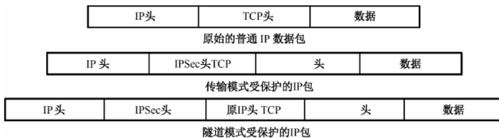
图 16-8 不同传输模式下的 IP 包
