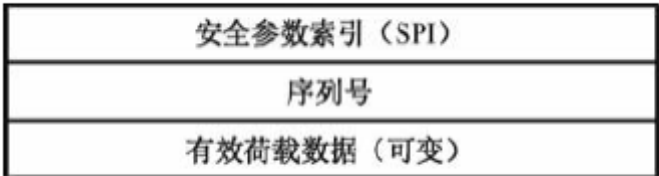
图 16-6 ESP 头的格式
