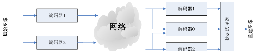
图 9.5 两个独立流的 MD 系统模型
