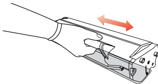
3. 取下保护罩，将激光碳粉盒沿导轨放入打印机
