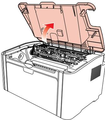
2. 打开定影上导向，使减轻定影压簧的压力。
