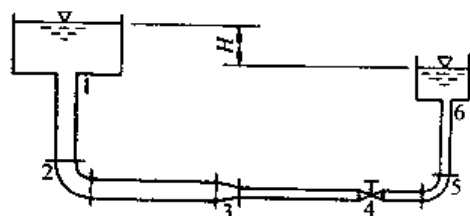
图 6.5-9 用管道连通的水箱
