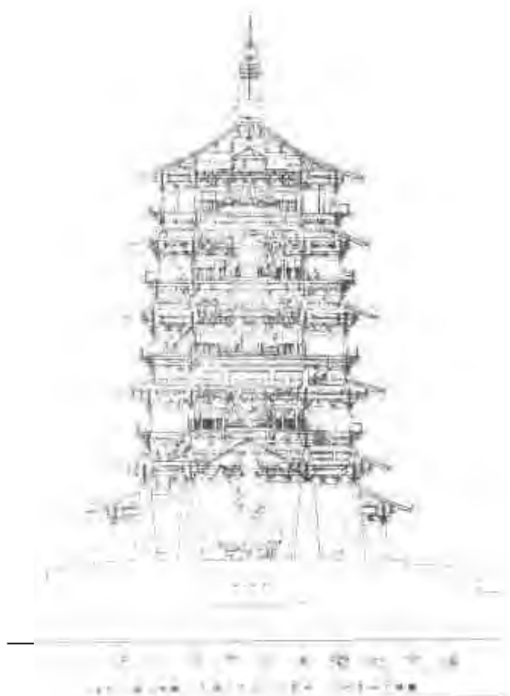
第 64 图 山西应县佛宫寺释迦塔断面图
