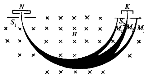
图 13-27 180^\circ 磁偏转型氦质谱检漏仪原理图
