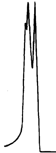
图 16-51 液氮胆内注入氮气时,相应的氮峰质谱图
