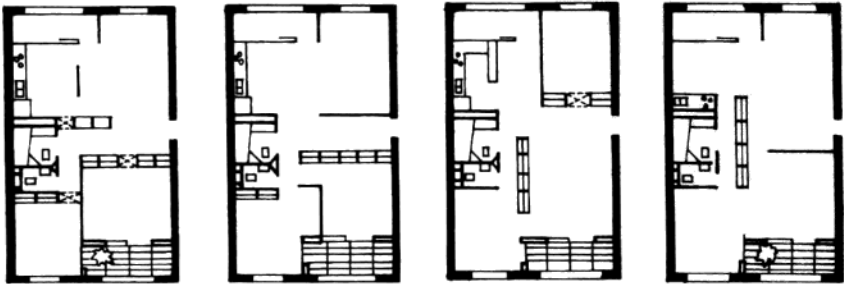
图 6-10 利用灵活隔断和壁柜盒子改变套型
