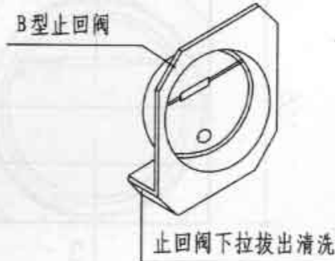
B型止回阀安装示意
