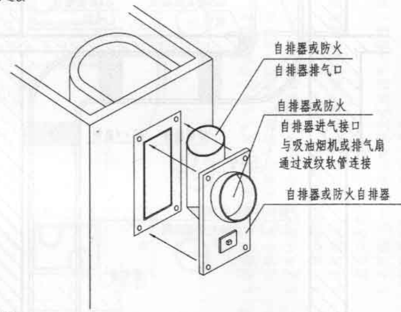
自排器或防火自排器安装示意图
