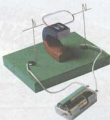
图10 通电的线圈放在磁场中会转起来，为什么？
