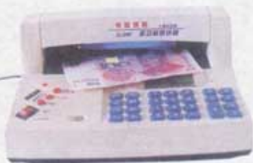
图4.5-7 紫外线使钞票上的荧光物质发光
