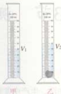
图6.3-2 用量筒测量不规则形状物体的体积
