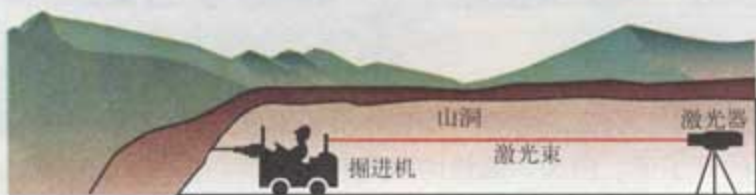
图4.1-4 激光引导掘进方向
