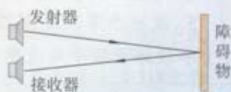
图1.4-3 超声波测距原理
