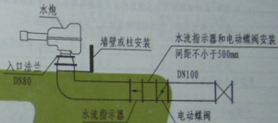
墙或柱水炮安装图
