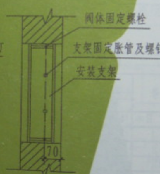
FXY-III 型泄压阀支架安装图
