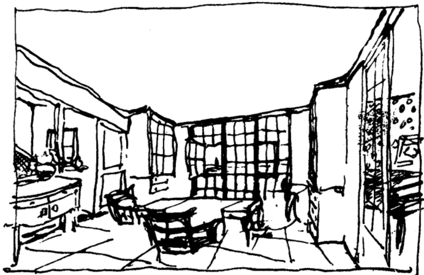
勒·柯布西耶 1915年，钢筋混凝土住宅内部 大批生产的窗，大批生产的门，大批生产的壁橱。窗子由一个、两个、一打部件装配起来。一扇门有一个亮子，两扇门有两个亮子，或者两扇门没有亮子，等等。柜子上部装玻璃，下部装抽屉放书本和工具等等。所有这些东西都由大工业提供，按照共同的模数制造，互相之间精确地适应。房子的框架造成之后，这些家具等安装到适当的位置去，用小枋子暂时固定，空隙用塑料片、砖块和木片填塞：通常的造房子方法被倒转过来，省掉几个月的工期。人们得到了非常重要的建筑统一，依靠模数，得到了住宅内部的良好比例
