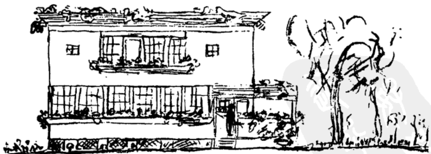
钢筋混凝土住宅。住宅与作坊 墙不承重，房子四周通连窗子
