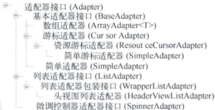
图 4-19 适配器继承关系层次结构示意图
