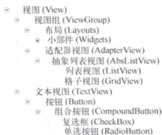
图 4-1 Android 可视组件架构示意图
