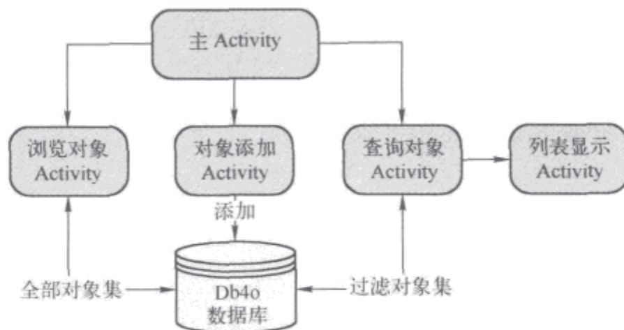
图 7-19 日记账工具的组件关联示意图
