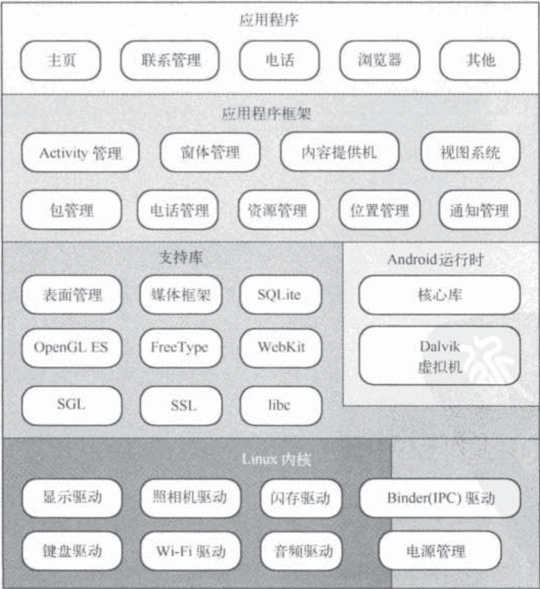
图 1-5 Android 平台架构图
