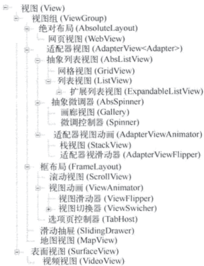
图 4-17 视图组件的继承关系层次结构示意图
