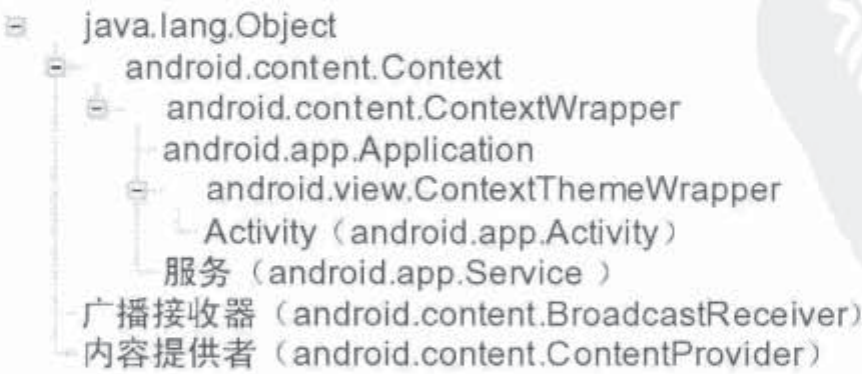
图 3-1 Android 应用程序组件的类结构层次
