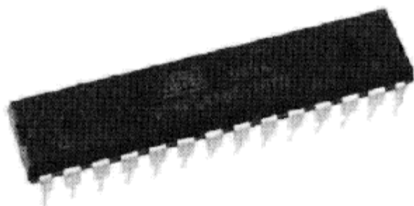
图 1-22 一块 Atmega168P 芯片，Arduino 开发板的核心（感谢 Earthshine Electronics 供图）
