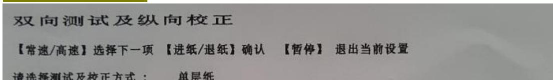
3. 或者再按**常速/高速键**，单层纸将被替代，出现多层纸选择，如图：(图示 2)
