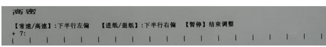
6. 按**常速/高速键**是将竖线向左调整，按**进/退纸键**是将竖线向右调整，如图：(图示 5)
