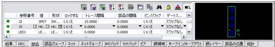
2. J3 をクリックして、**部品**タブからワークスペースにドラッグします。ポインタの動きに合わせて J3 が表示されます。
