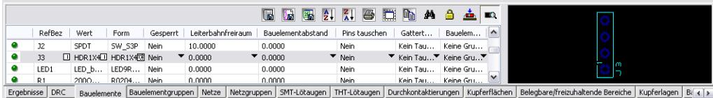
2. Klicken Sie auf J3 und ziehen Sie das Element von der Registerkarte **Bauelemente** in den Arbeitsbereich. J3 ist nun dem Mauszeiger unterlegt.
