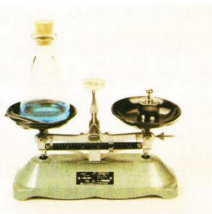
图5-3 铁钉与硫酸铜溶液反应前后质量的测定
