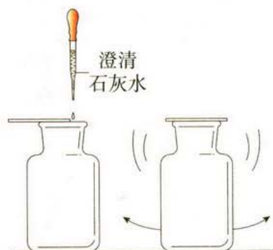
图1-18 用澄清石灰水检验
