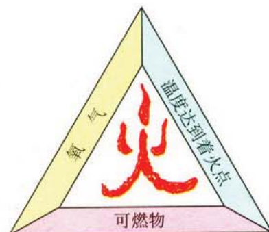
图7-6 燃烧条件示意图
