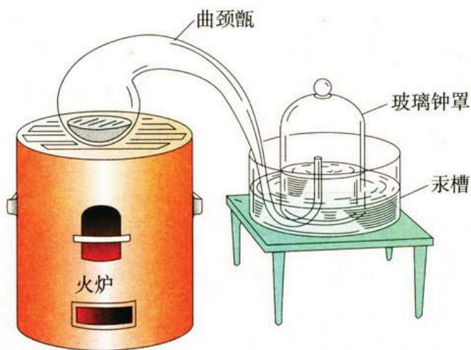
图2-2 拉瓦锡研究空气成分所用的装置
