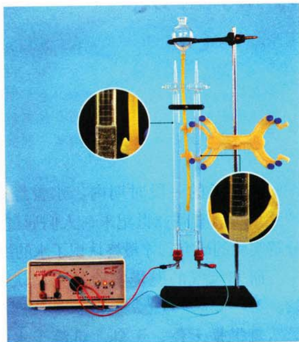
图4-25 电解水实验
