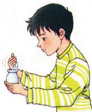
图1-5 闻气体时的正确操作
