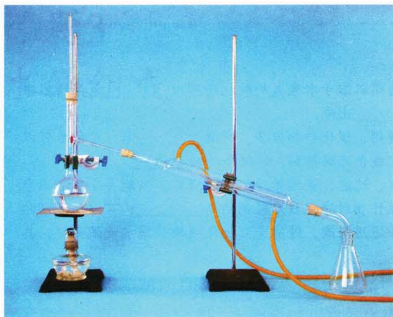
图4-20 实验室常用的蒸馏装置
