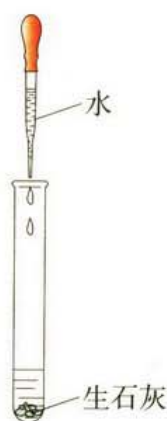
图7-14 生石灰与水反应放出热量
