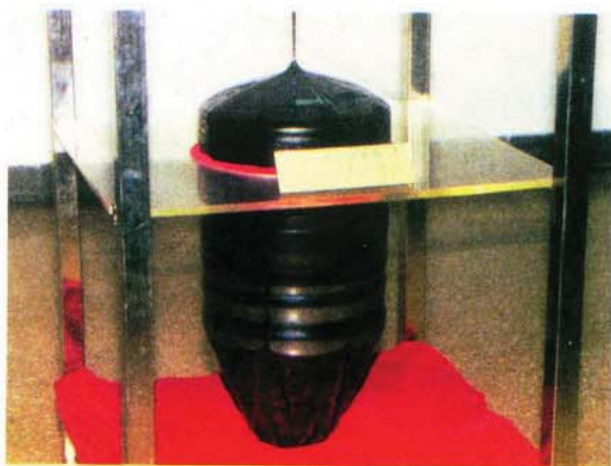
图9 单晶硅为信息技术和新能源开发提供了基础材料
