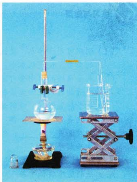
图4-21 制取蒸馏水的简易装置
