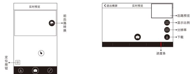
竖屏预览:APP连接记录仪成功后,竖屏状态下点击播放图标可进行竖屏实时预览,预览界面右边会有前后路切换按钮,点击可切换到后路,预览界面下方为实时位置显示;
