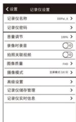
依次进入“我—设置—记录仪设置—记录仪存储管理—点击左上角格式化按钮”,对TF卡进行格式化。
