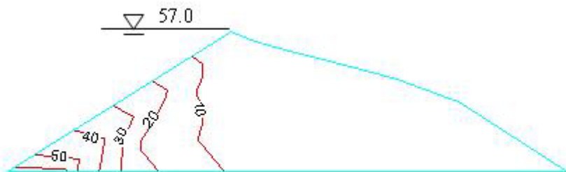
图 7.7.5 稳定渗流时坝体的孔隙压力分布 ( t = 1 天)
