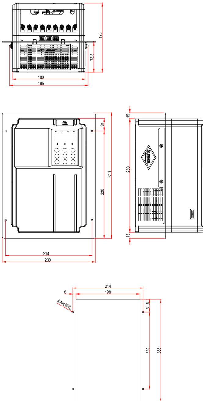
图 8-7 MD500T15GB 中部安装支架及开孔尺寸
