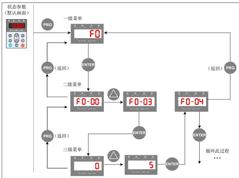
图 4-2 三级菜单操作流程图
