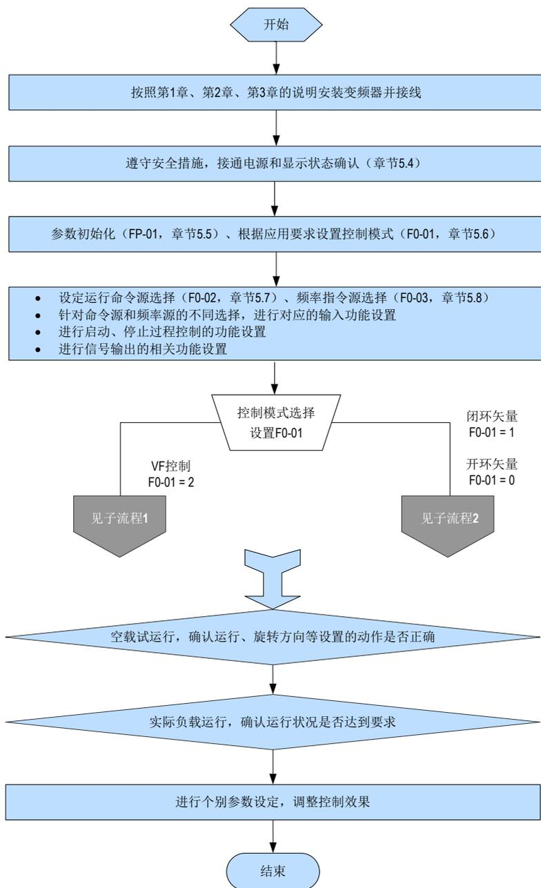
图 5-2 变频器调试总流程图
