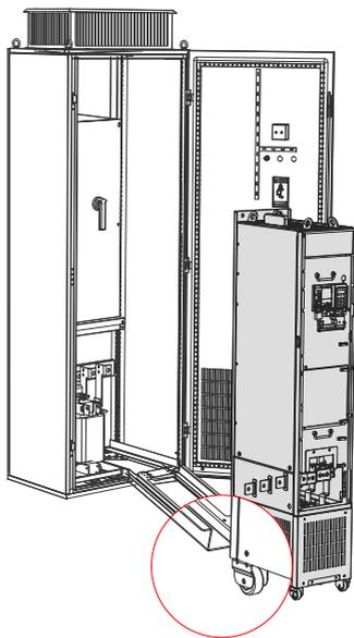
图 3-19 将变频器脚轮对准安装导轨
