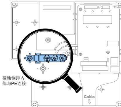
MD500在结构上进行了整机接地处理,在完成PG卡安装后,可实现与PG卡PE端子的内部连接;进行编码器接线时,只需将信号线的屏蔽层引出后接入该PG卡上的PE端子,即可完成信号线的屏蔽层接地。
