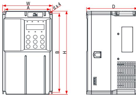
图 8-1 MD500T0.4GB ~ MD500T15GB 外型尺寸及安装尺寸示意图
