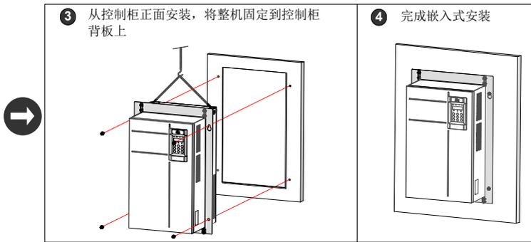
图 3-10 MD500T45G(B)~MD500T160G 机型嵌入式安装示意图
