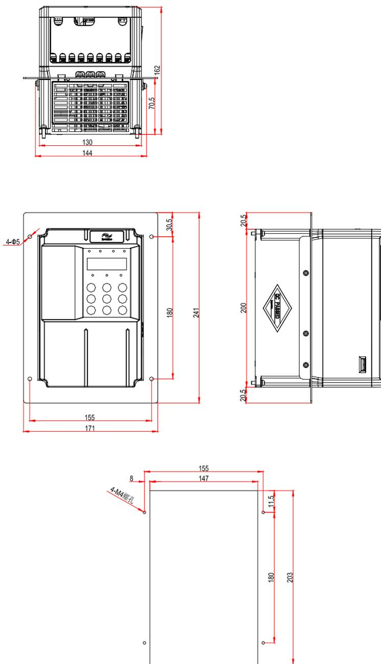
图 8-5 MD500T3.7GB ~ MD500T5.5GB 中部安装支架及开孔尺寸
