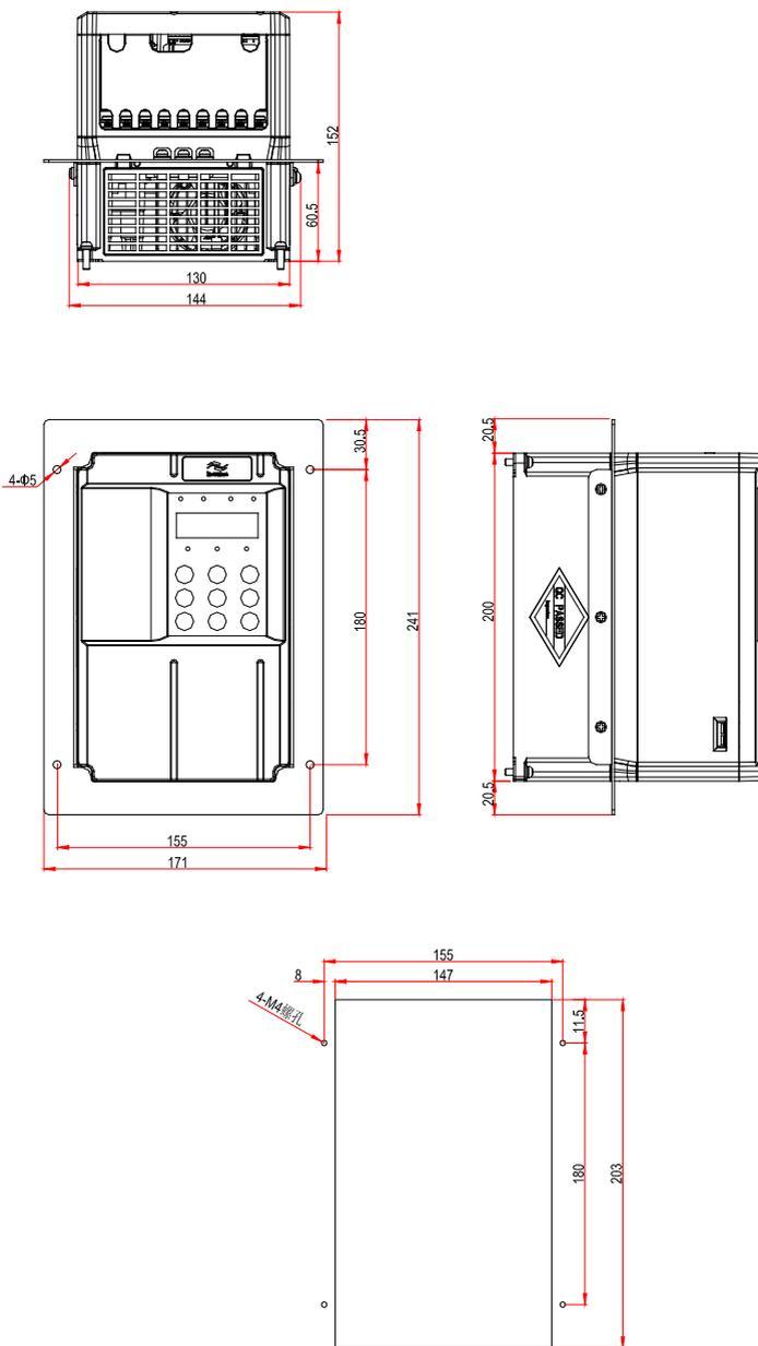
图 8-4 MD500T0.4GB ~ MD500T3.0G(B) 中部安装支架及开孔尺寸
