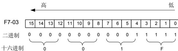
其他状态参数的查看方法，同 F7-03 的方法。状态参数在 F7-03、F7-04、F7-05 的每一字节的对应关系如下：
