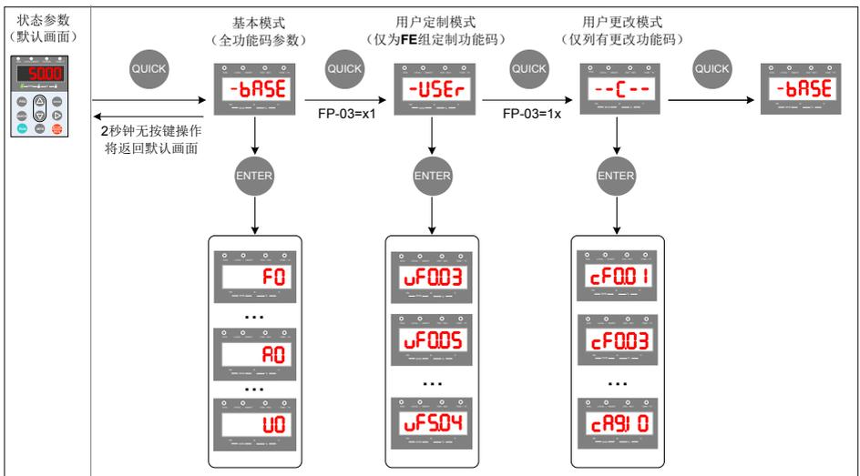
图 4-5 功能码参数查阅方法示意图
