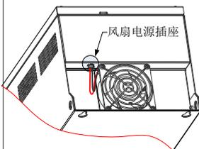
用螺丝刀将风扇罩上的四颗固定螺钉卸下
