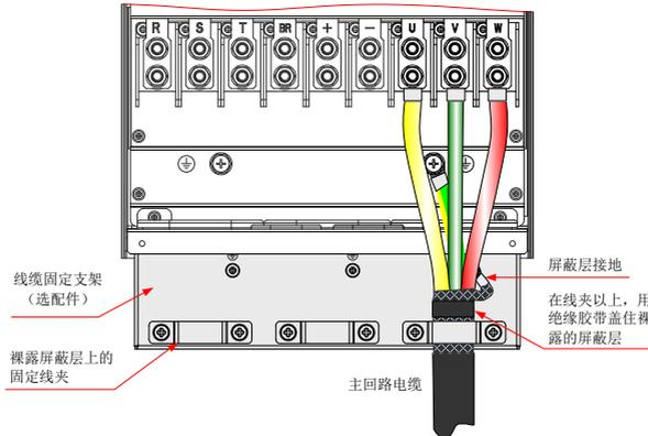
图 3-33 屏蔽层接线
