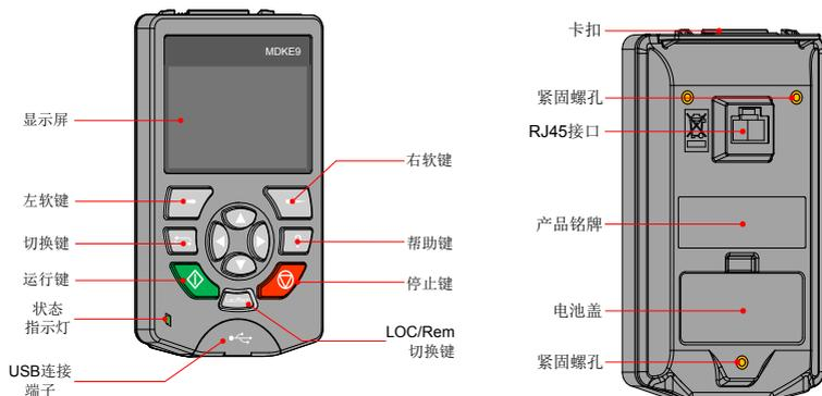
图 4-6 LCD 外引操作面板（MDKE9）外观示意图
