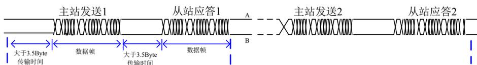
MD500 系列变频器内置的通信协议是 Modbus-RTU 从机通信协议，可响应主机的“查询/命令”，或根据主机的“查询/命令”做出相应的动作，并通讯数据应答。
