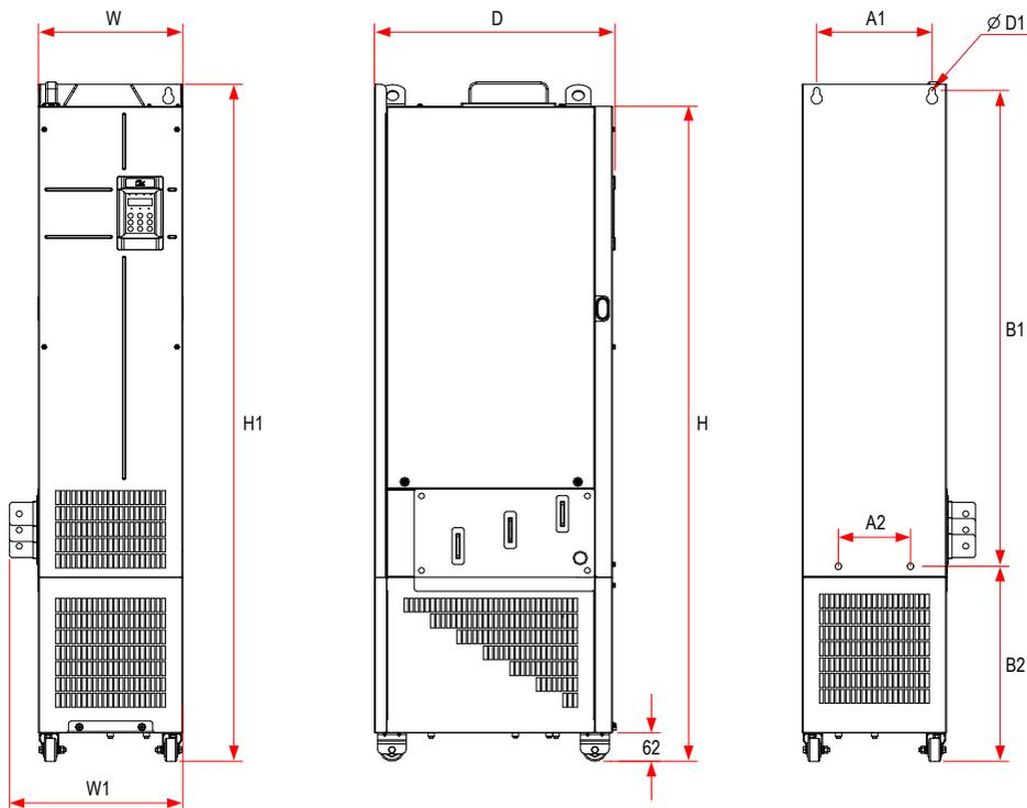
图 8-14 MD500T200G-L~ MD500T450G-L 外型尺寸及安装尺寸示意图（带电抗器底座）
