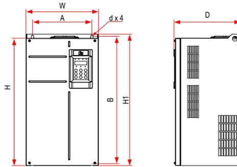
图 8-3 MD500T45G(B) ~ MD500T160G 外型尺寸及安装尺寸示意图
