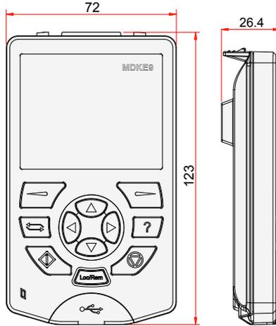
图 8-24 MDKE9 外引操作面板尺寸
