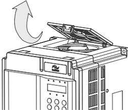
将风扇向上提起后，将电源线插头从插座上拔下，完成拆卸。
