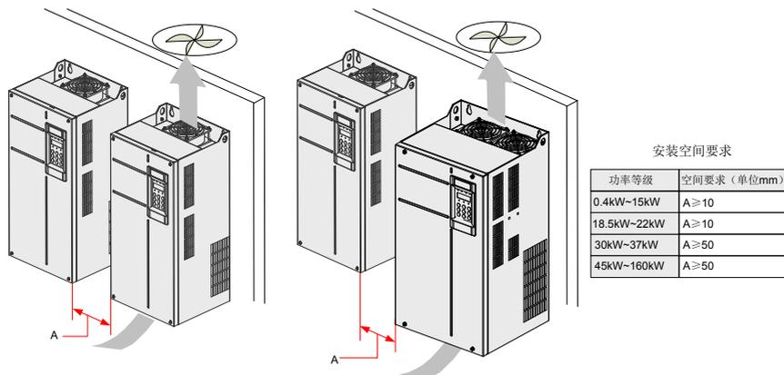
图 3-4 [MD500T0.4GB ~ MD500T160G] 多台机器并排安装
