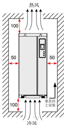
图 8-19 MDBUN 系列制动单元安装空间要求 (单位: mm)
