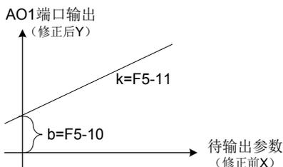
图 5-12 AO 信号修正特性曲线
