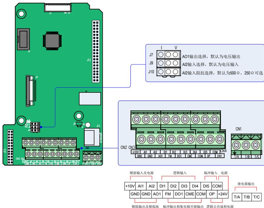
图 3-39 控制回路端子布置图
