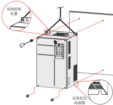
图 3-8 MD500T45G(B) ~ MD500T160G 机型壁挂式安装示意图
