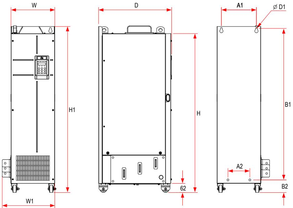
图 8-13 MD500T200G ~ MD500T450G 外型尺寸及安装尺寸示意图
