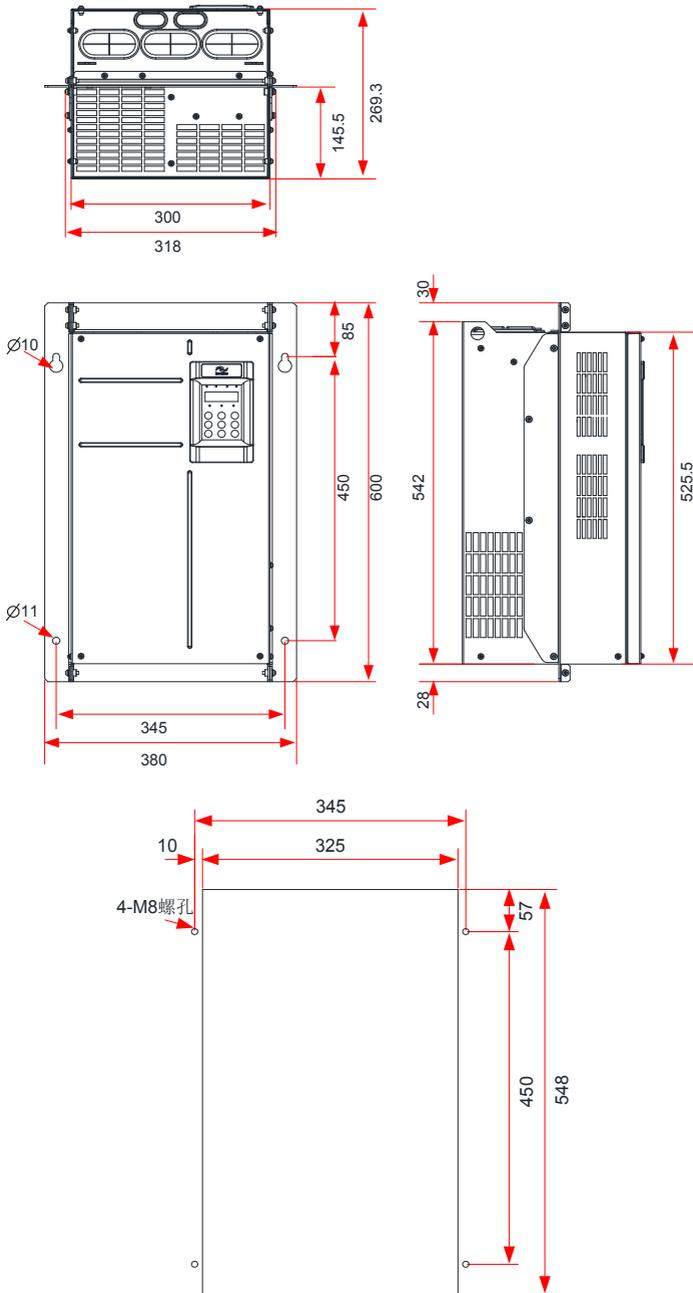
图 8-10 MD500T45G(B) ~ MD500T55G(B) 中部安装支架及开孔尺寸
