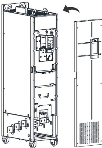
② 安装六颗固定螺钉，用螺丝刀分别拧紧，完成盖板安装。
