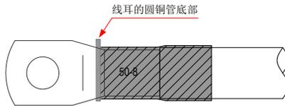
图 3-36 线缆导体加套管热缩示意图
