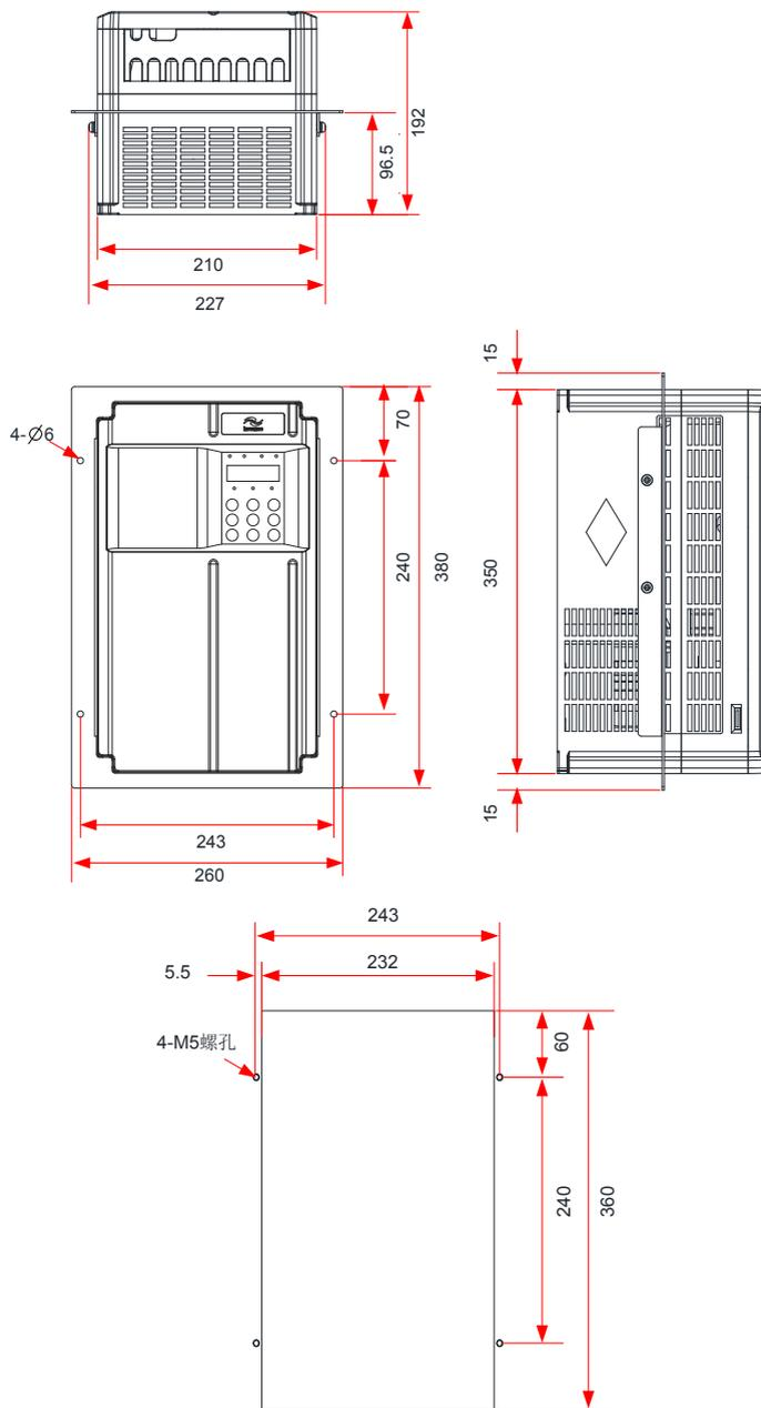
图 8-8 MD500T18.5G(B)-(T) ~ MD500T22G(B)-(T) 中部安装支架及开孔尺寸
