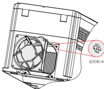
④ 将风扇罩上的两个小卡扣插入机体扣槽, 轻轻按下固定卡扣:
