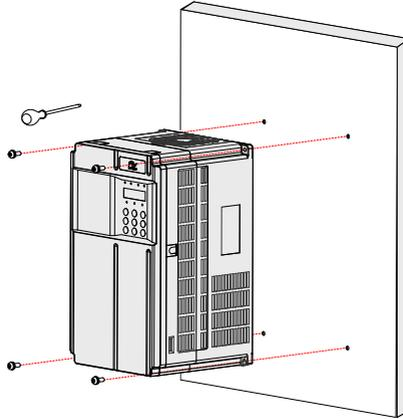
图 3-7 MD500T0.4GB ~ MD500T37G(B) 机型壁挂式安装示意图
