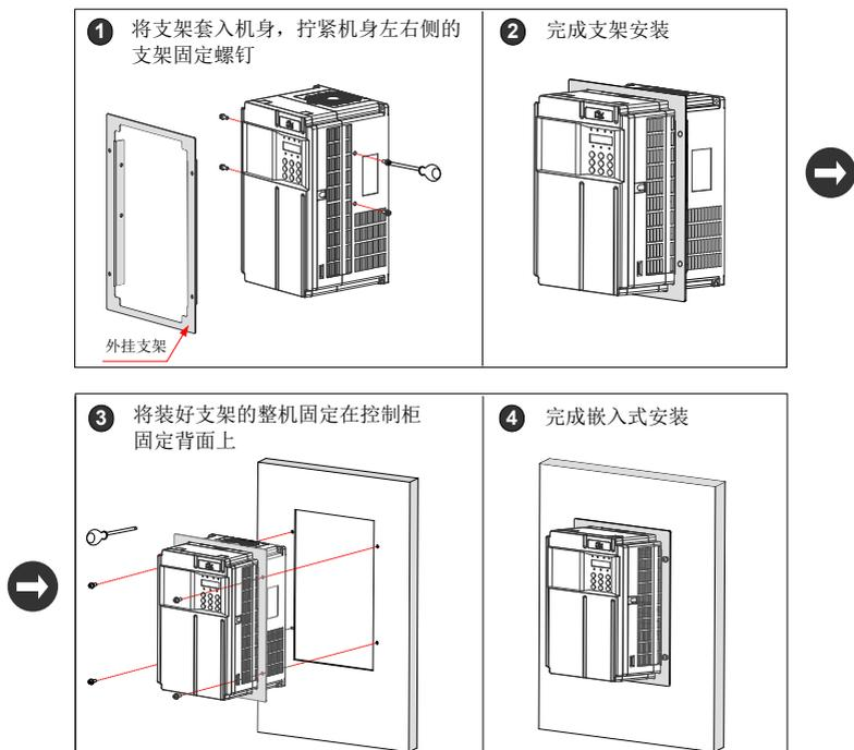
图 3-9 MD500T0.4GB ~ MD500T37G(B) 机型嵌入式安装示意图
