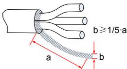
图 3-35 电机电缆屏蔽层引出示意图
