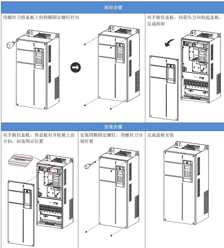
图 3-24 MD500T45G(B) ~ MD500T160G 机型盖板拆卸与安装
