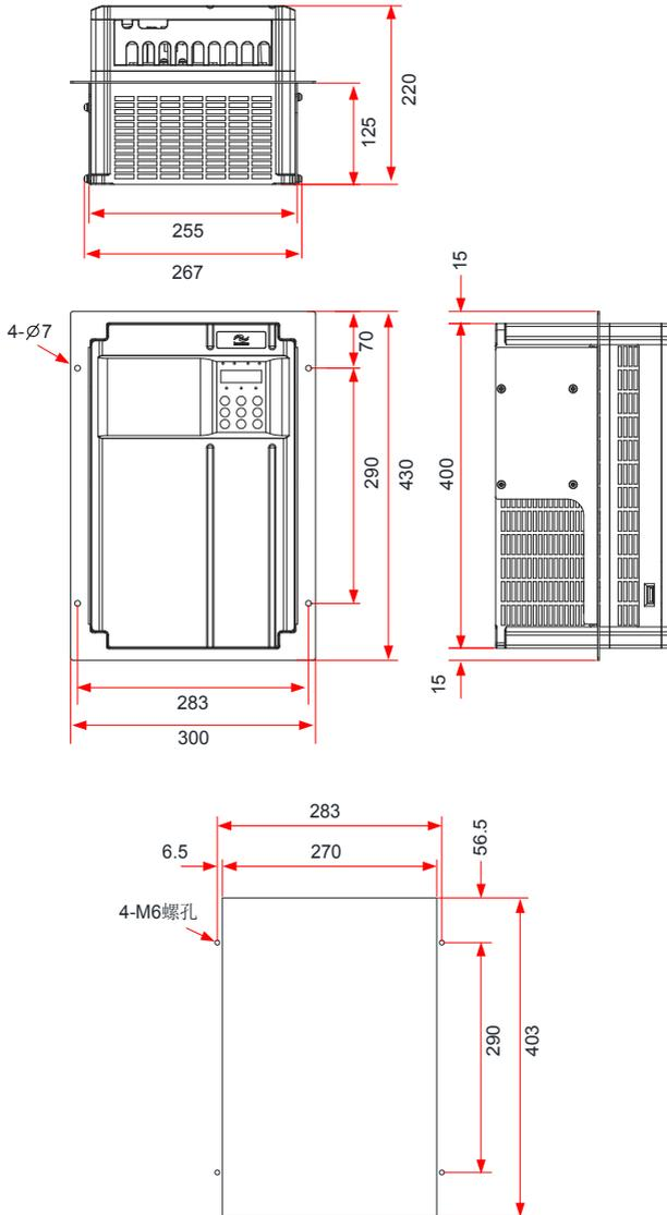
图 8-9 MD500T30G(B) ~ MD500T37G(B) 中部安装支架及开孔尺寸
