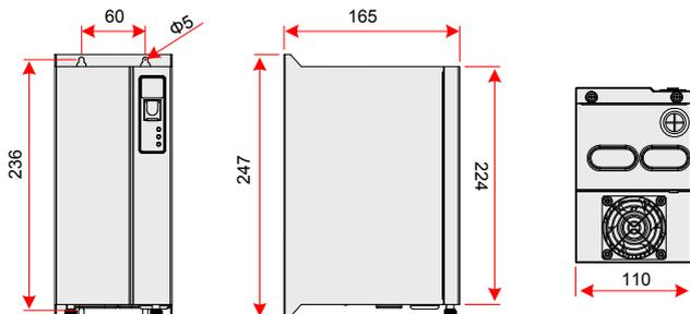
图 8-18 MDBUN 系列制动单元外形尺寸图（单位：mm）
