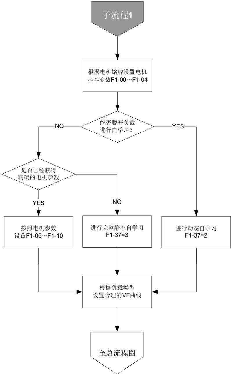
图 5-3 变频器调试子流程图 1 (V/F 控制)
