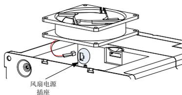
③ 将风扇放入机体安装部位, 放入时注意要将风扇底部四个固定孔对准定位柱
