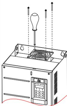
将风扇罩、风扇脱离机体, 完成风扇拆卸
