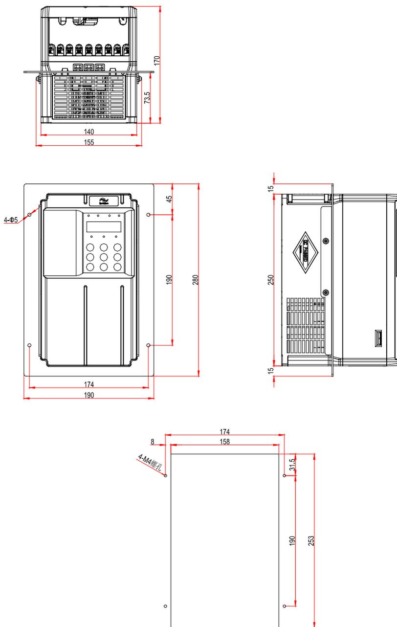
图 8-6 MD500T7.5GB ~ MD500T11GB 中部安装支架及开孔尺寸
