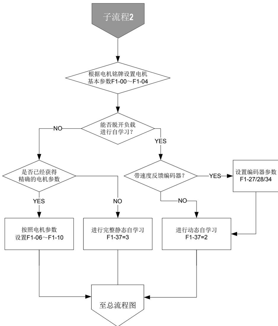
图 5-4 变频器调试子流程图 2（矢量控制）
