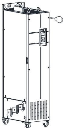
双手握住盖板，向箭头方向抬起盖板，完成盖板拆卸
