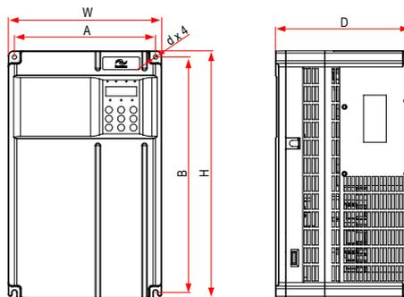
图 8-2 MD500T18.5G(B) ~ MD500T37G(B) 外型尺寸及安装尺寸示意图
