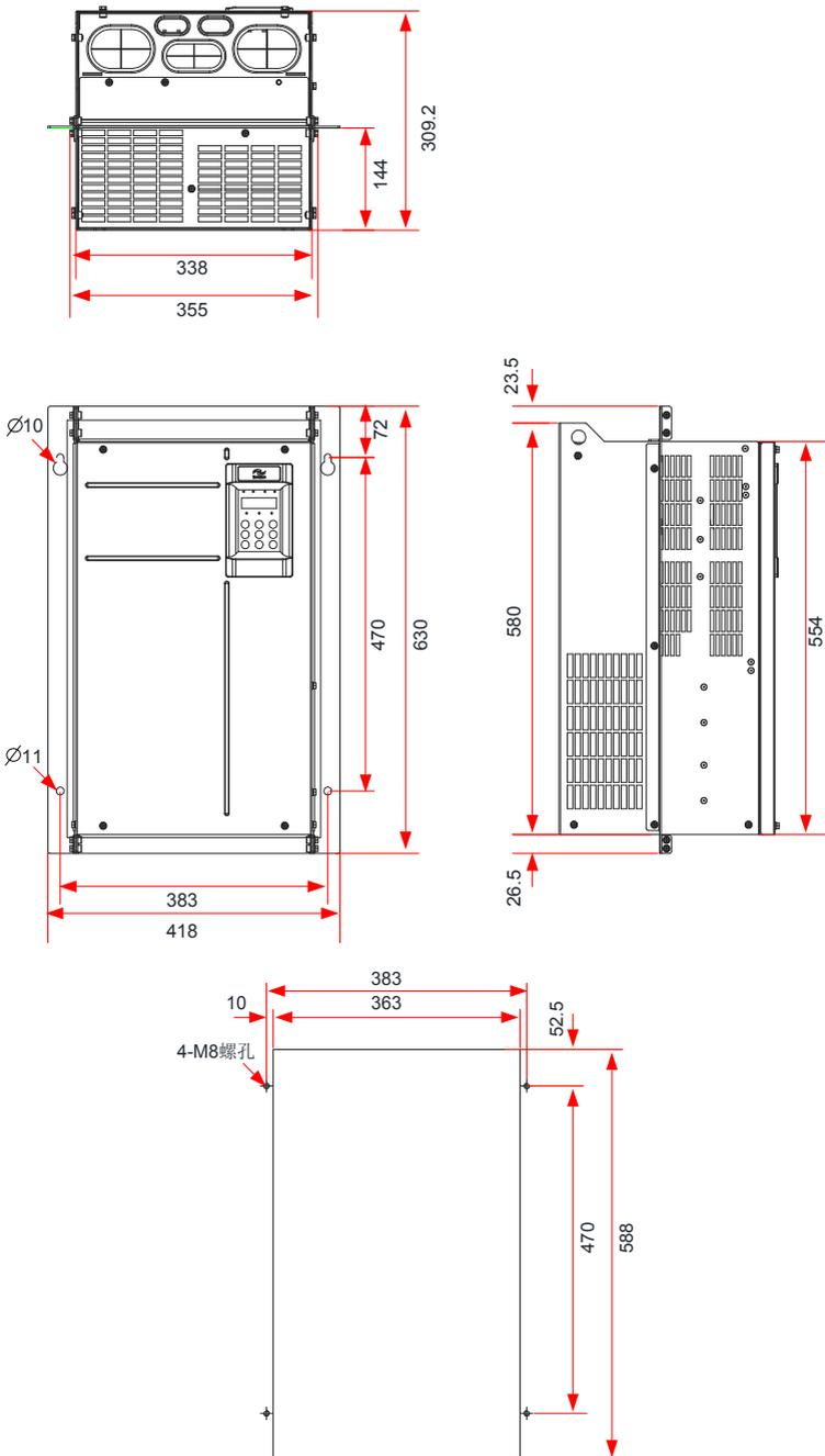
图 8-11 MD500T75G(B) ~ MD500T110G 中部安装支架及开孔尺寸
