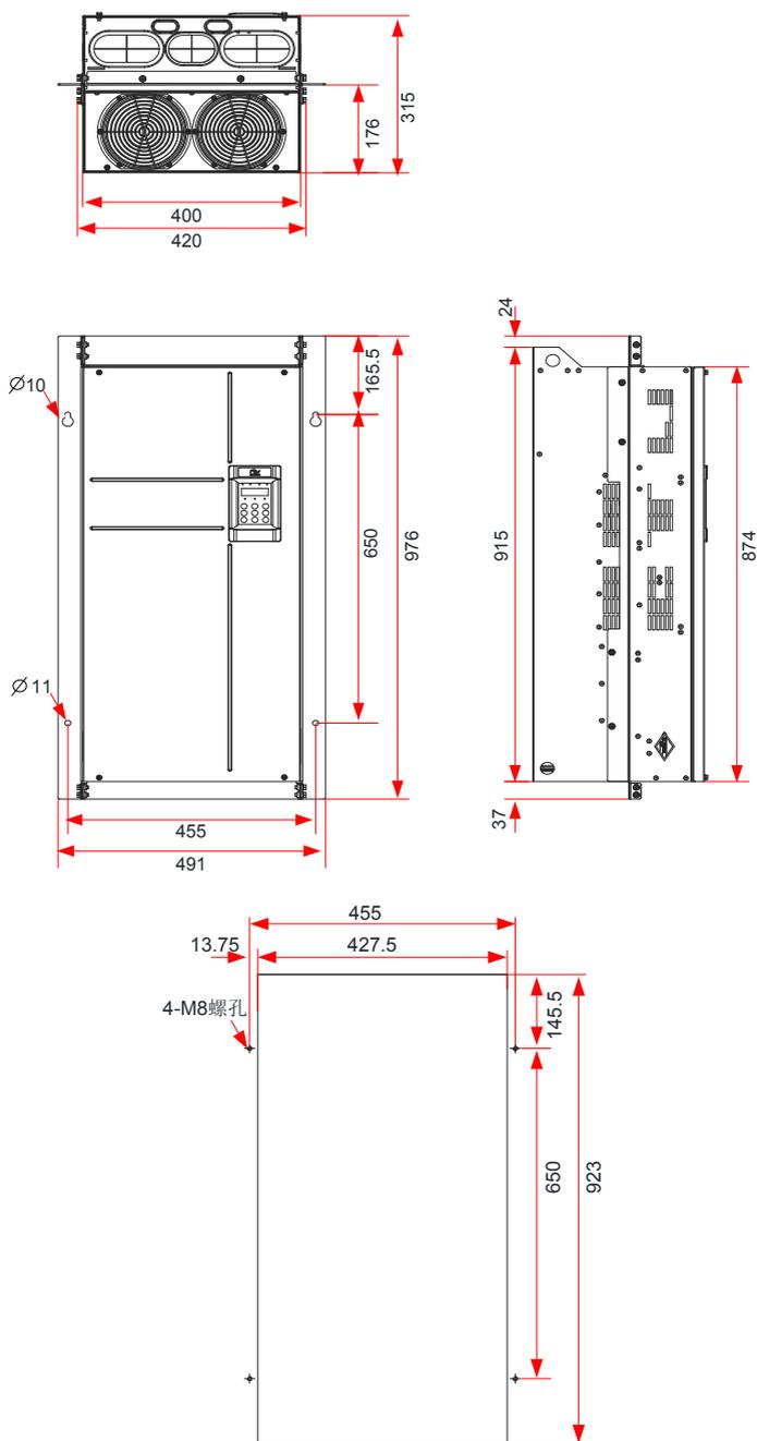
图 8-12 MD500T132G ~ MD500T160G 中部安装支架及开孔尺寸
