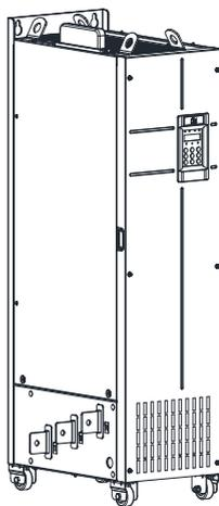
图 3-25 MD500T200G(-L) ~ MD500T450G(-L) 机型盖板拆卸与安装
