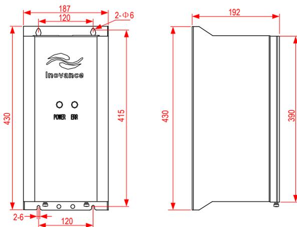
图 8-20 MDBU 系列制动单元外形尺寸图 (单位: mm)
