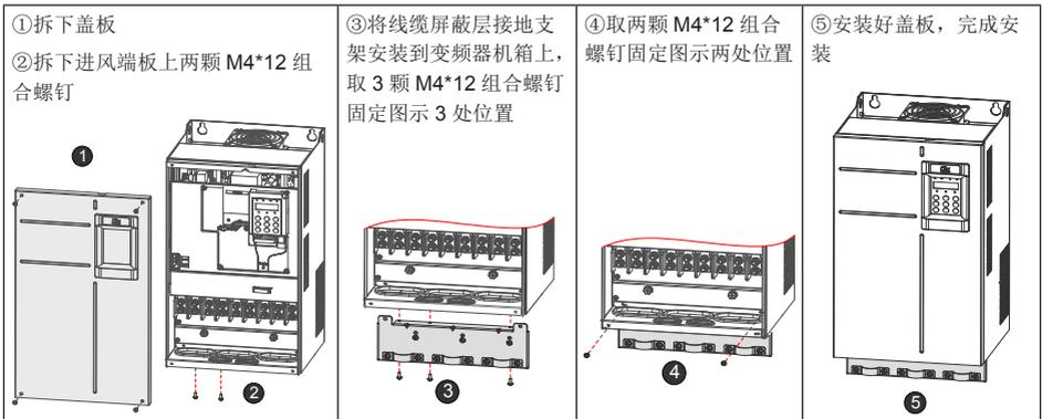
图 3-34 线缆屏蔽层接地支架安装示意图
