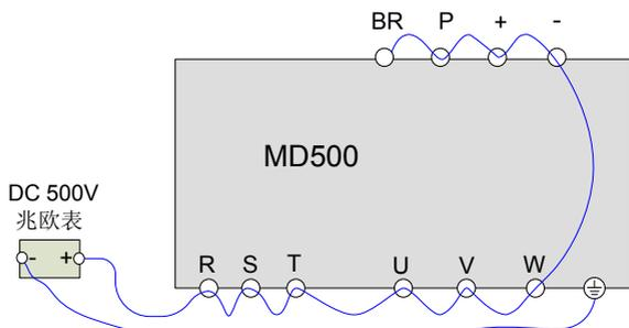
图 7-1 主回路绝缘测试示意图
