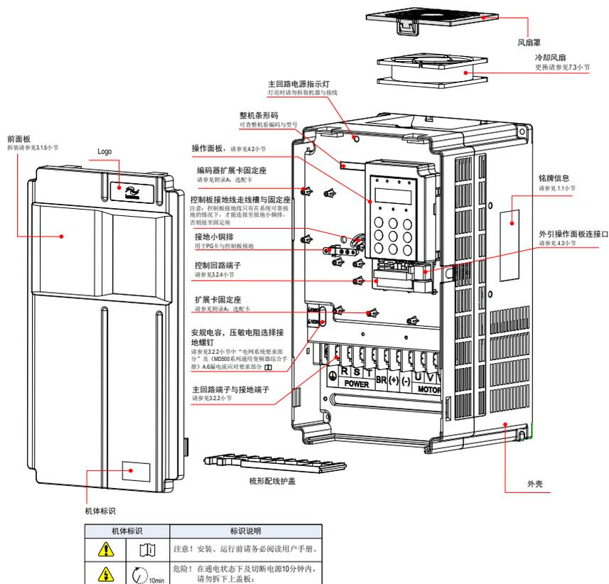
图 1-3 产品部件示意图【三相 380V ~ 480V, MD500T18.5G(B) ~ MD500T37G(B)】
