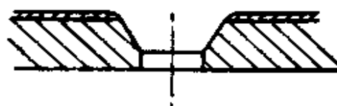
图 13.4 油孔加工和油槽倒角修棱(见 13.14 段)
