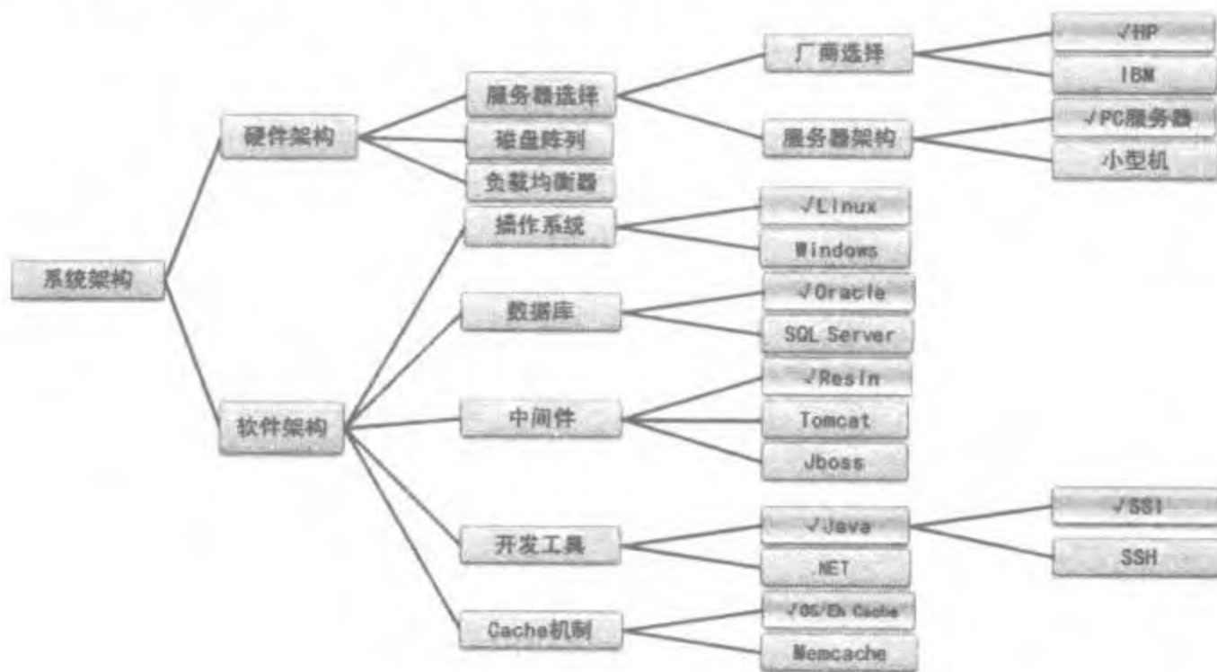
图 1-3 系统架构模型
