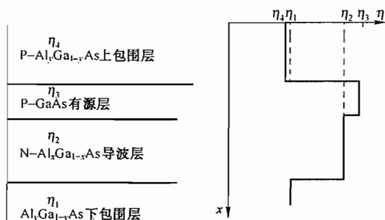
图 10.2.4 AlGaAs/GaAs 大光腔结构(四层介质波导)
