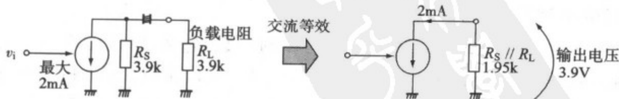
图 4.6 输出波形下半周被限幅的原因
