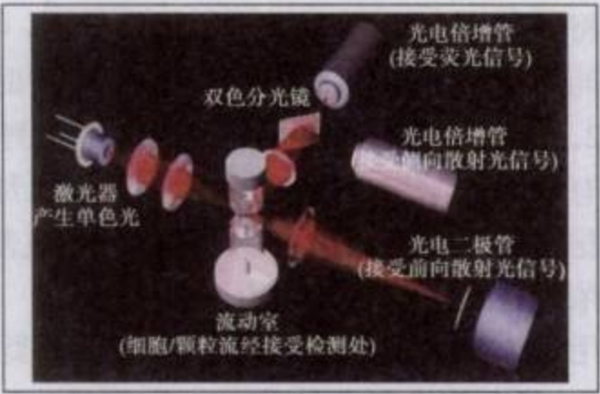
图 3-6 流式细胞术检测通道和光路系统
