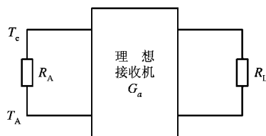
图 3.10 接收机内部噪声的换算
