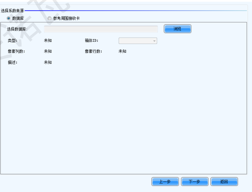
图5-68 从数据库获取新接收卡带载箱体的校正系数
