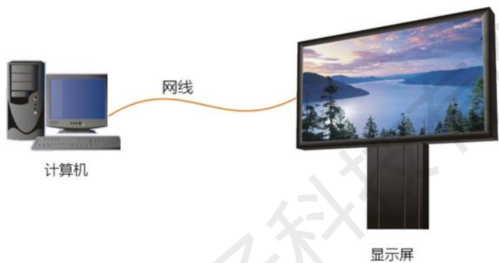
图1-2 无发送卡系统架构图
