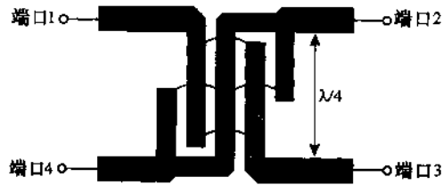
图 G.7 3 dB Lange 耦合器
