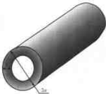
图 1.6 横截面积上的电阻增加,电流是限制在由趋肤厚度 \delta 定义的小面积内
