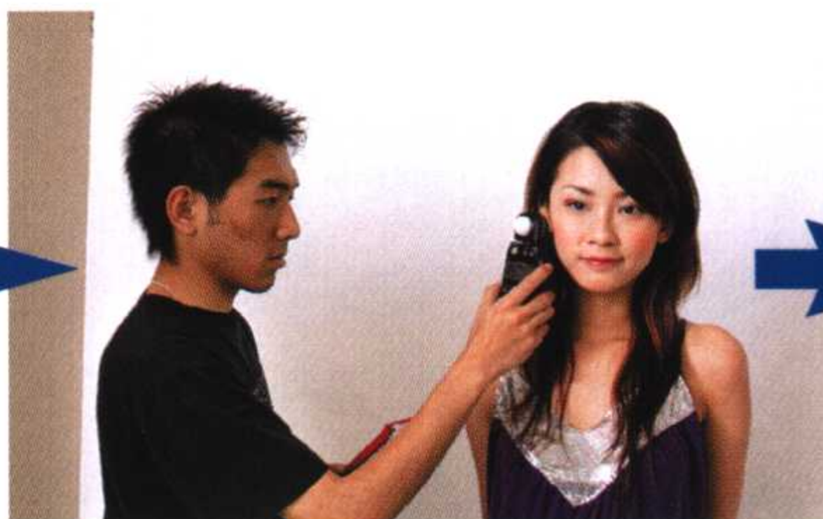
▲ 将测光表与影楼闪光灯以同步连接线接上，并将测光表设定为1/60秒快门及ISO 100感光值，在左边测光。
