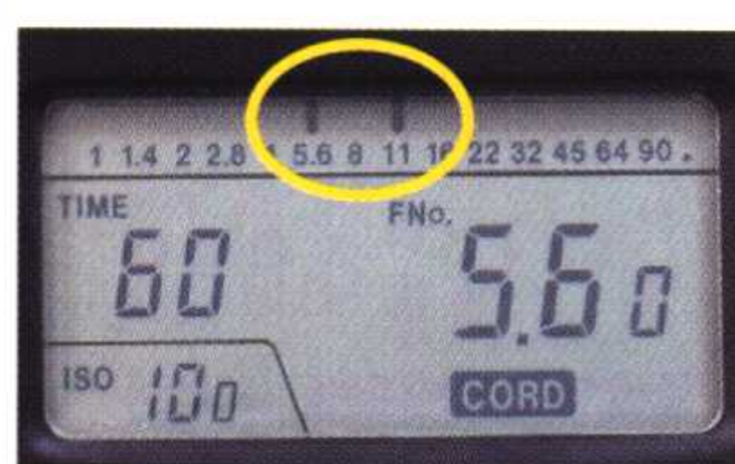
▲ 作第二次测光，光圈值为F5.6，但留意“光圈刻度尺”中，除了有第二次测光时的数值(F5.6)外，也保留了第一次测光时所显示的光圈值“F1.1”，不会消去。
