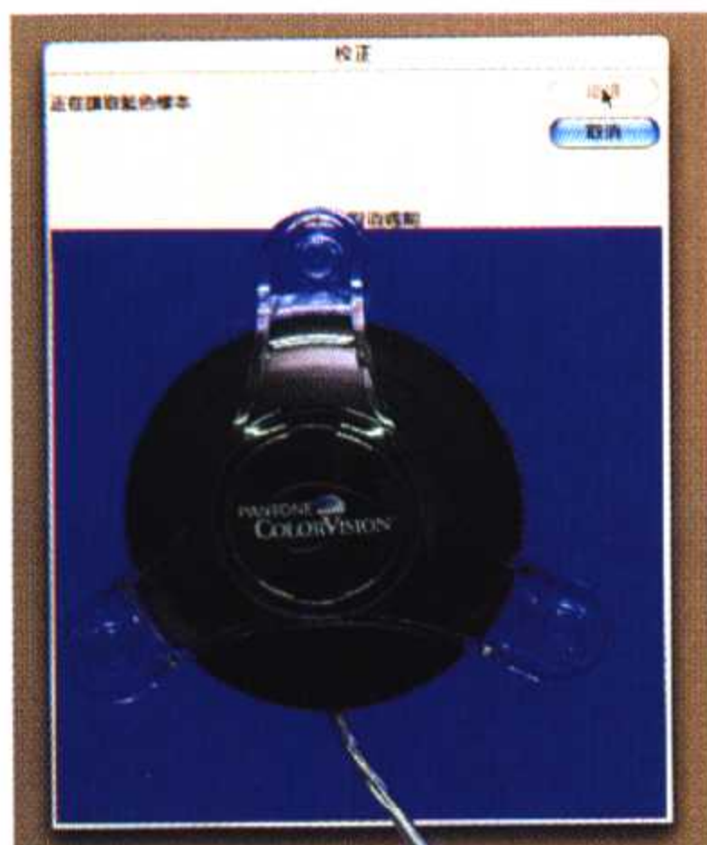
▲接下来，就要使用“OptiCAL”软件。在“显示器”一栏选择你所用的显示器型号，同时选择显示器的类型，CRT就是一般的显示屏，而LCD就是液晶显示器。然后是“目标”栏中的“曲线”，假如是苹果电脑的话请选用“1.8”，假如是用Windows系统的PC电脑就用“2.2”，由于这次使用的是苹果电脑，所以选用“1.8”，“白色点”一栏就选“6500K”，这是适用于一般室内白炽灯环境下的数值。其他的请用默认值，最后按“校正”继续。
