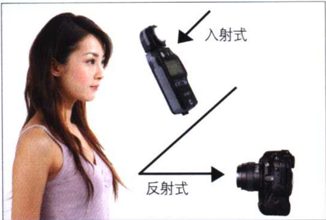
反射式测光与入射式测光的原理
