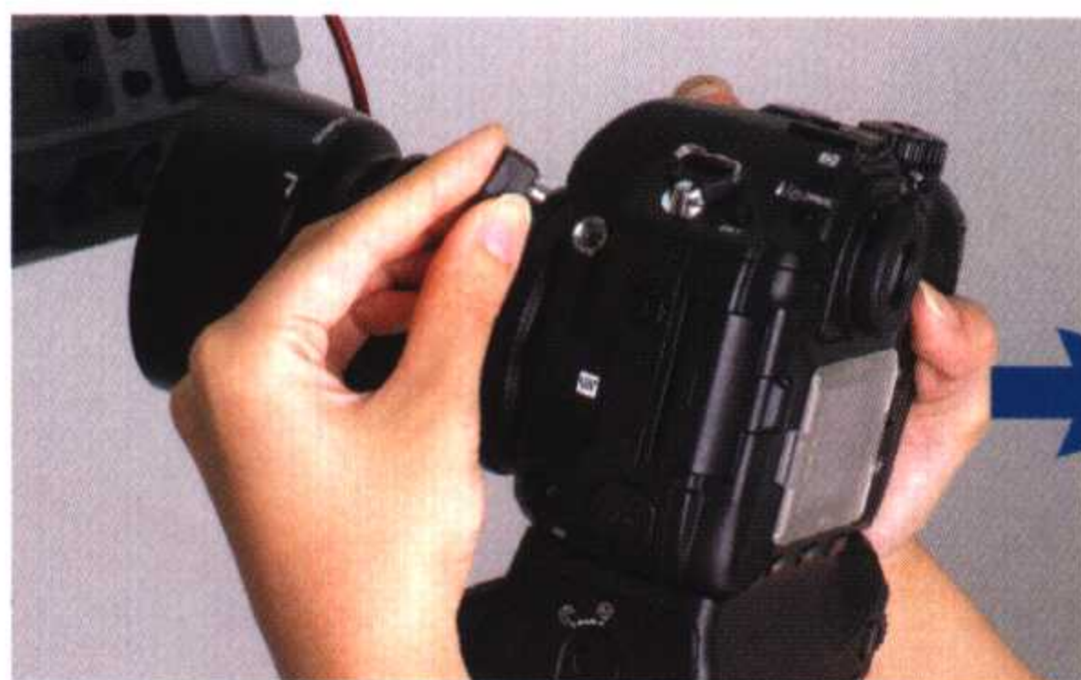
▲ 完成测光后，将连接于测光表的同步连接线除去，将同步连接线接在相机的同步端子，以手动模式设定快门为1/60秒，ISO 100感光值及将光圈调校为 F16，就可以正式开始拍摄了。
