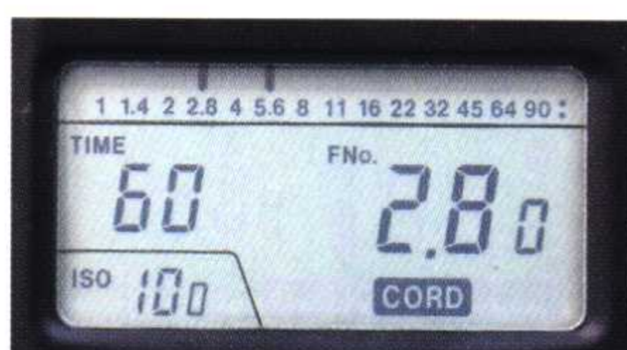
▲ Minolta Meter IV F的记忆空间只有两个，若此时再按下记忆按钮，则第三个数值(F2.8)会占用了第一个测光数值(F1.1)的记忆空间。故第一个数值也会从光圈刻度尺中消失。
