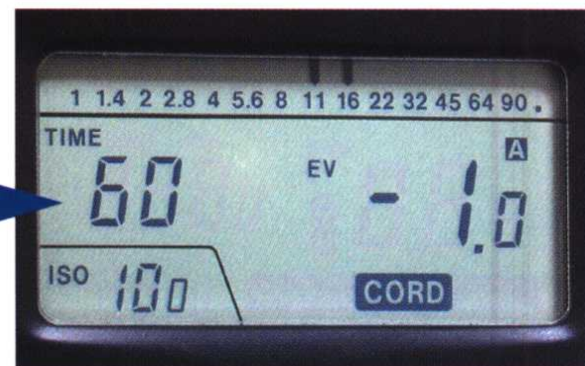
▲ 显示屏会显示出第一次测光与这次测光两者的相差数值，若是显示“EV-1.0”的话，表示右边的光亮度比左边的光亮度低一级。若不是的话就要调校影楼灯，重复第二次测光的步骤来测光。
