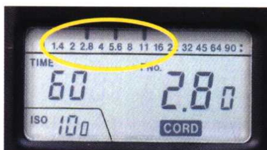
▲ 作第三次测光，光圈值为F2.8。留意光圈刻度尺中，除了有第三次测光时的数值(F2.8)外，也保留了第一及第二次测光时所显示的光圈值“F1.1”及“F5.6”，不会消去。
