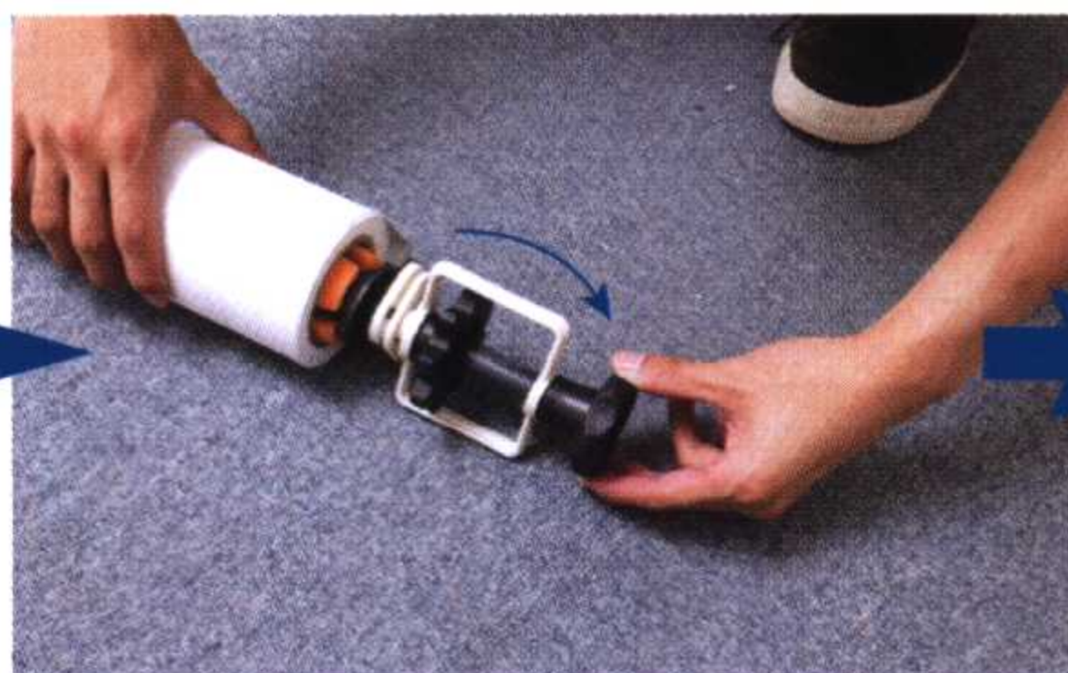
▲ 以箭头方向转动，转轴的黄色部分就会拱起，压着色纸卷的内壁，将色纸卷扣实。
