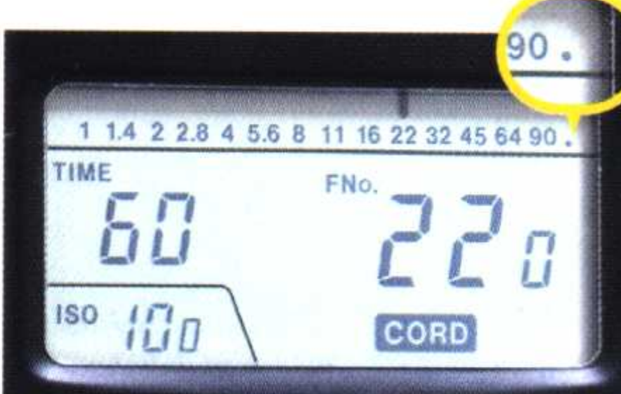
▲ 作第一次测光，光圈值为F2.2，按下记忆按钮将数值储存。留意在显示屏的右上角多了一点，表示已记下该数值。
