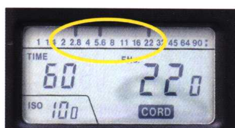
▲ 作第四次测光。光圈值为F2.2。由于第一次测光的数值已被删除，所以光圈刻度尺中只会显示第二、三及第四次的测光数值。
