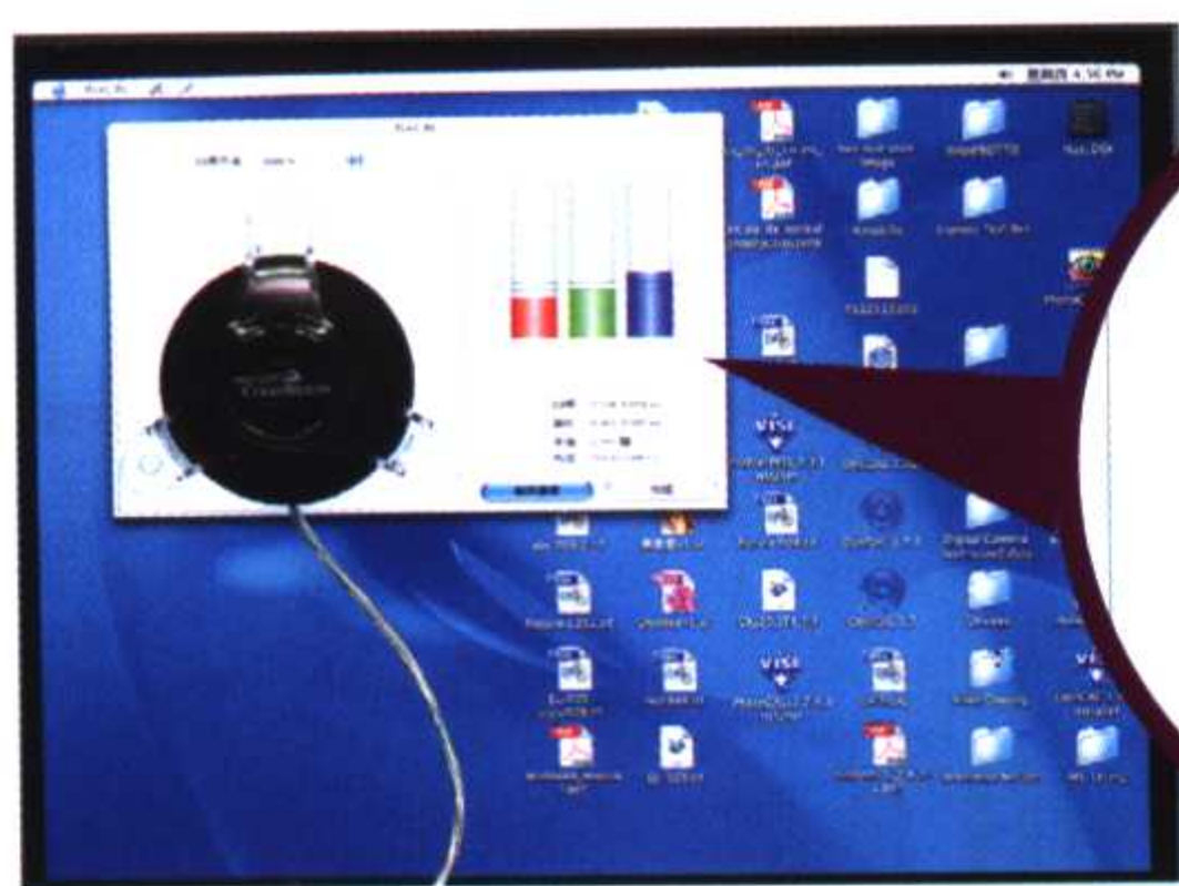
▲色彩测量仪测量到RGB三色的色彩比例，从资料显示，三色的比例并不正确。
