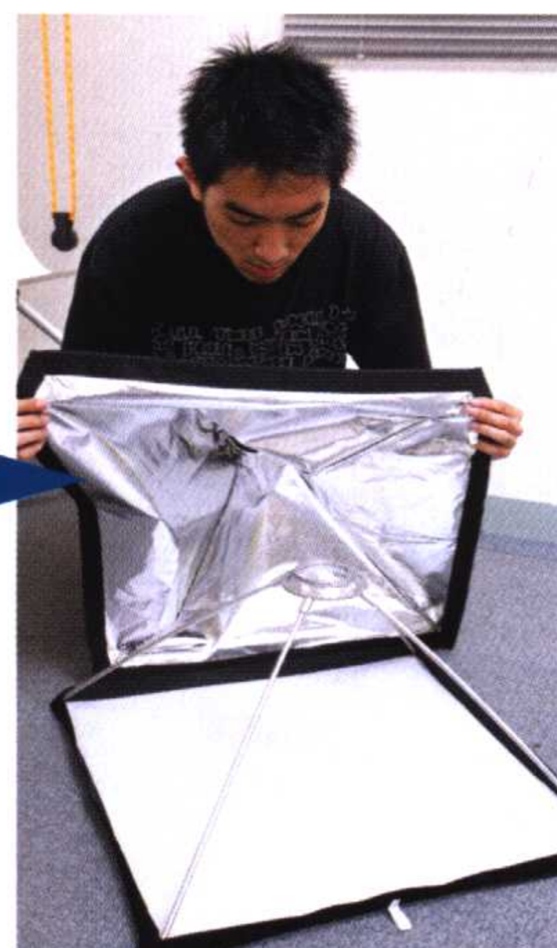
▲ 再套上外面黑色，里面银色(银色可将光线反射)的外套。
