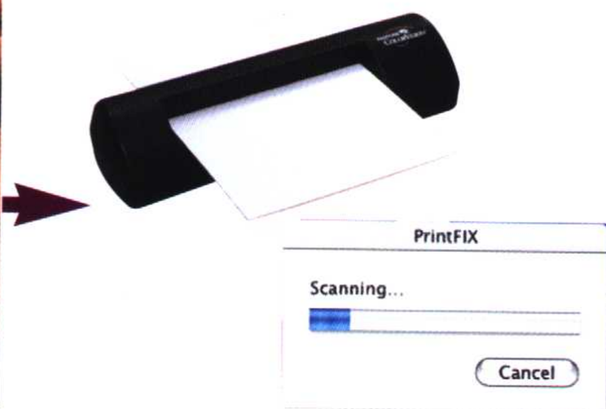
▲将它放在色彩测量仪(扫描仪)，把R800打印出来的色板输入电脑。
