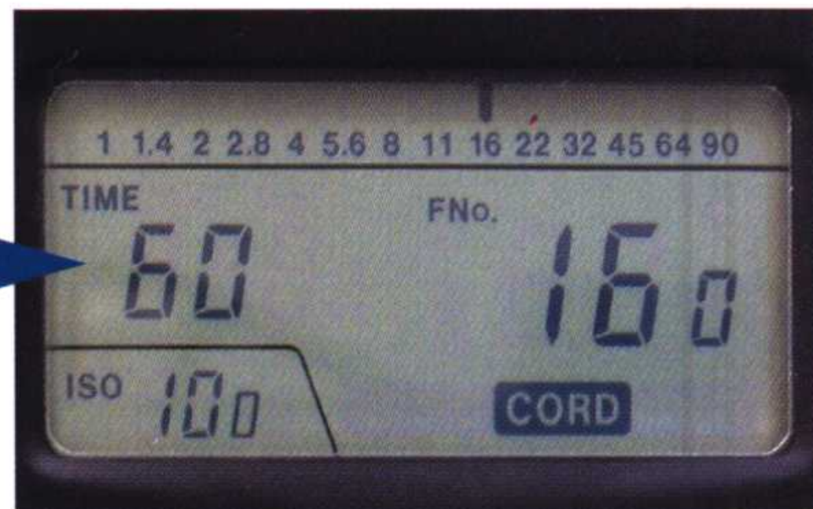
▲ 调校影楼闪光灯的输出，直到测光表测得光圈值是F16。
