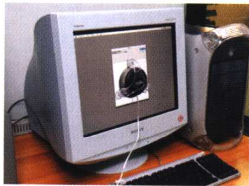
▲这个附在显示屏上的色彩测量仪就是用来量度显示屏的色彩是否正确的。
