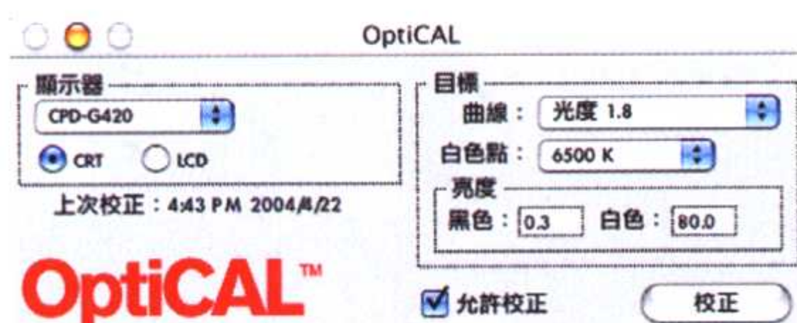
▲接下来，就要使用“OptiCAL”软件。在“显示器”一栏选择你所用的显示器型号，同时选择显示器的类型，CRT就是一般的显示屏，而LCD就是液晶显示器。然后是“目标”栏中的“曲线”，假如是苹果电脑的话请选用“1.8”，假如是用Windows系统的PC电脑就用“2.2”，由于这次使用的是苹果电脑，所以选用“1.8”，“白色点”一栏就选“6500K”，这是适用于一般室内白炽灯环境下的数值。其他的请用默认值，最后按“校正”继续。
