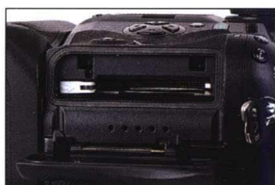
▲记忆卡插槽设有防水胶边，其实全机的多个接口也有同样设计，令外E-1还具有防水能力。
