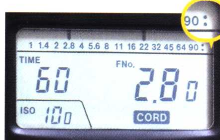
▲ 作第二次测光，光圈值为F2.8，按下记忆按钮将数值储存。留意在显示屏的右上角再多了一点(共两点)，表示已记下该数值。
