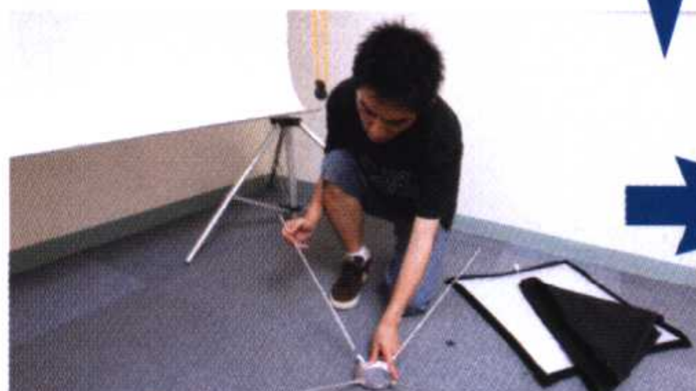
▲ 接下来就要组合柔光罩。先将四支钢枝安装在钢圈的卡口(Mount)上。
