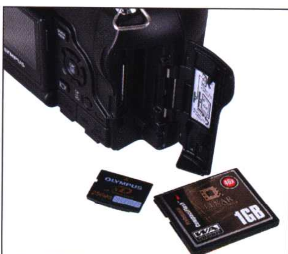
▲同时使用xD-Picture及CompactFlash TypeI/II记忆卡(兼容MicroDrive)。
