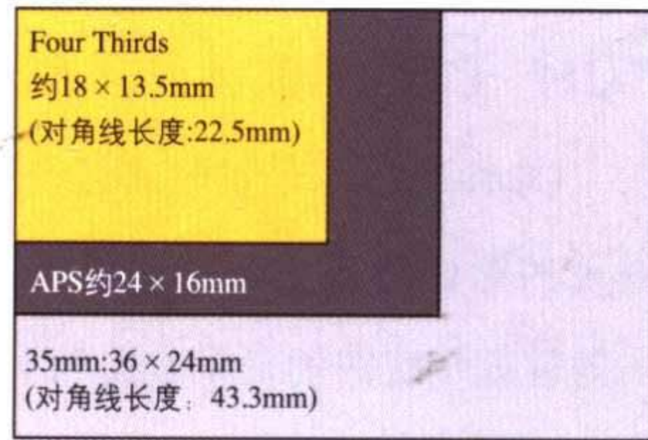
▲Four Thirds System的影像感应器比135胶片面积小，故镜头可造得更小。
