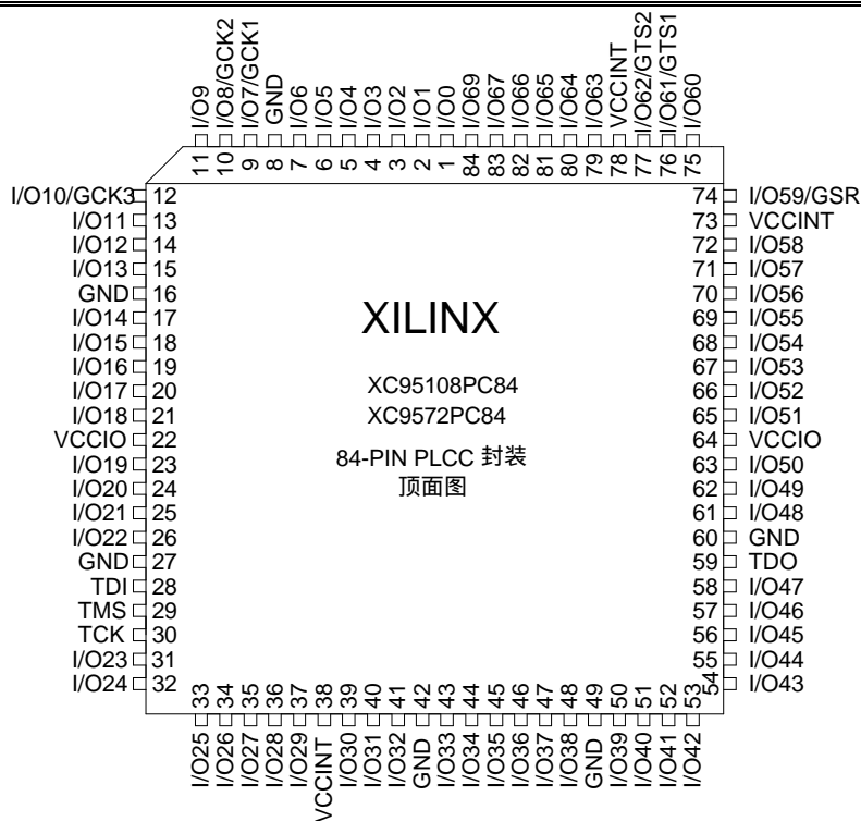
附图 2-4 XILINX XC95108/72-PC84 顶视引脚图
