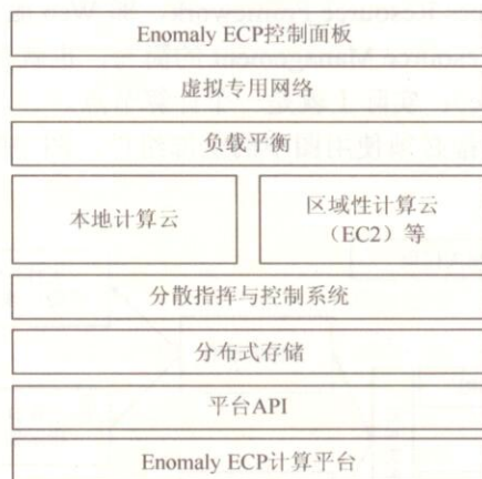
图 8-1 Enomaly ECP 架构
