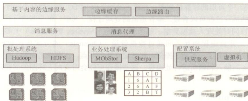
图 10-19 Yahoo 云计算平台的体系结构和核心服务组件
