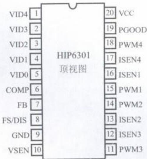
图8-4 HIP6301芯片引脚图
