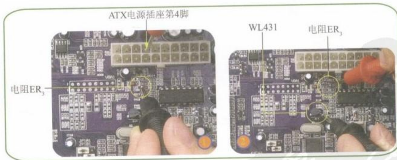
图8-62 测量电源插座到精密稳压器的线路
