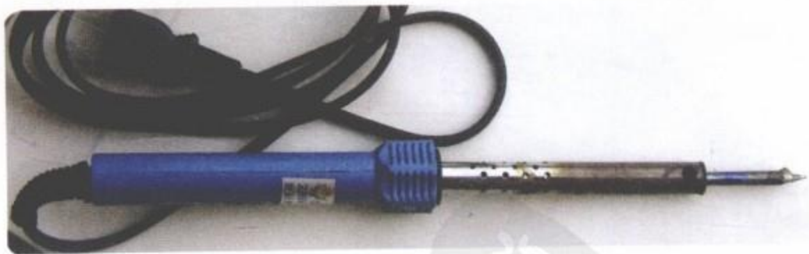
图2-4 电烙铁
