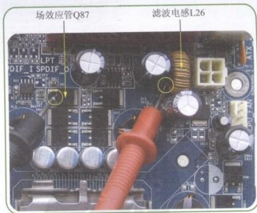
图8-52 测量电感 L_{26} 到高端门场效应管 Q_{87} 的D极的线路
