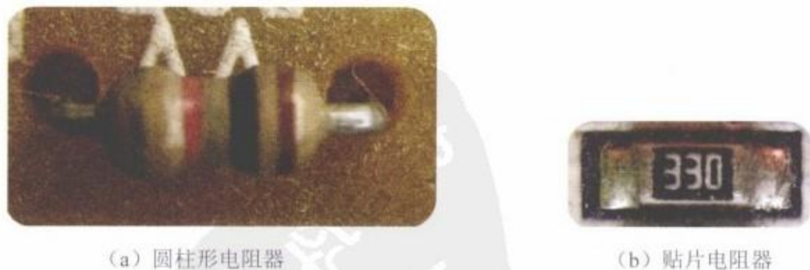
图2-17 贴片电阻器和圆柱形电阻器
