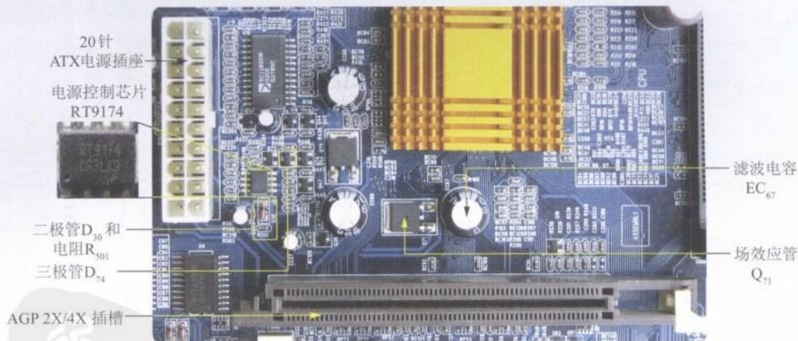
(b) 专用电源芯片组成的AGP显卡供电电路实物图
