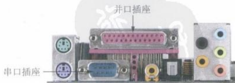
图5-5 主板的串口和并口
