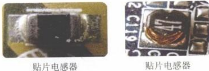
图2-36 平面电感器
