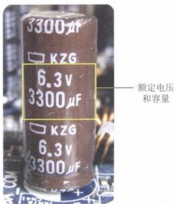
图2-30 电容器上标注的额定电压和容量
