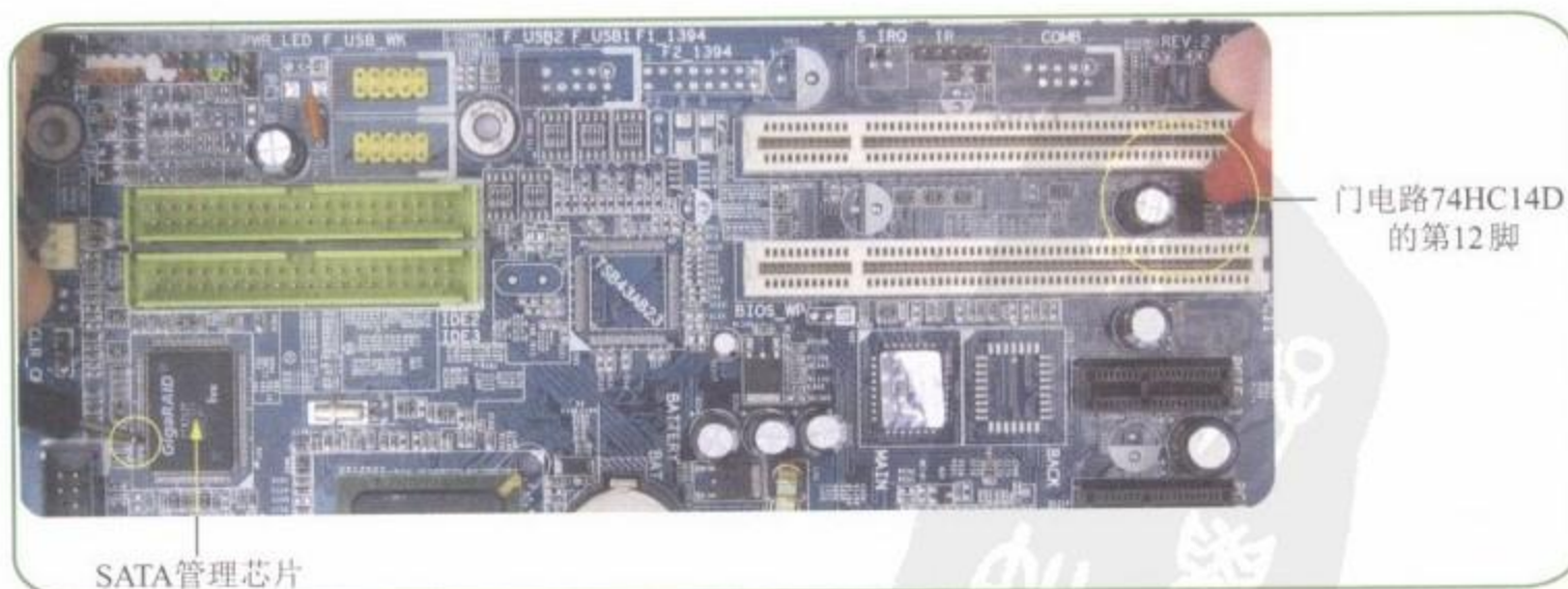
图10-24 测量门电路芯片到SATA管理芯片的线路
