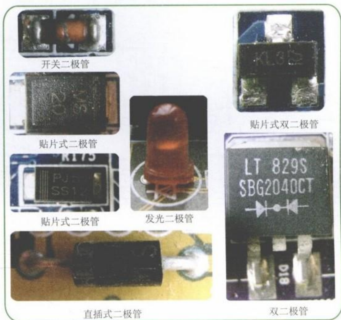
图2-40 主板中常用的二极管
