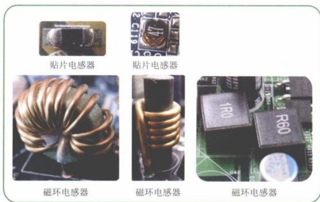
图2-33 主板中的电感器
