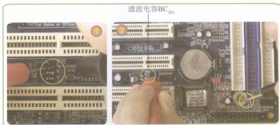
图6-22 三端稳压器输入脚连接滤波电容的线路
