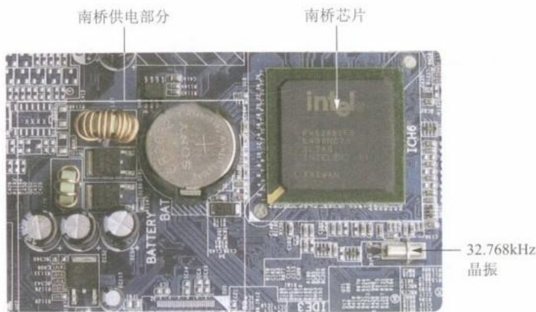
图7-3 南桥芯片的供电电路及时钟电路
