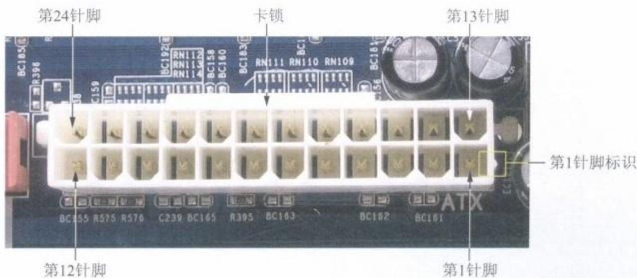
图5-23 24针ATX电源插座针脚顺序
