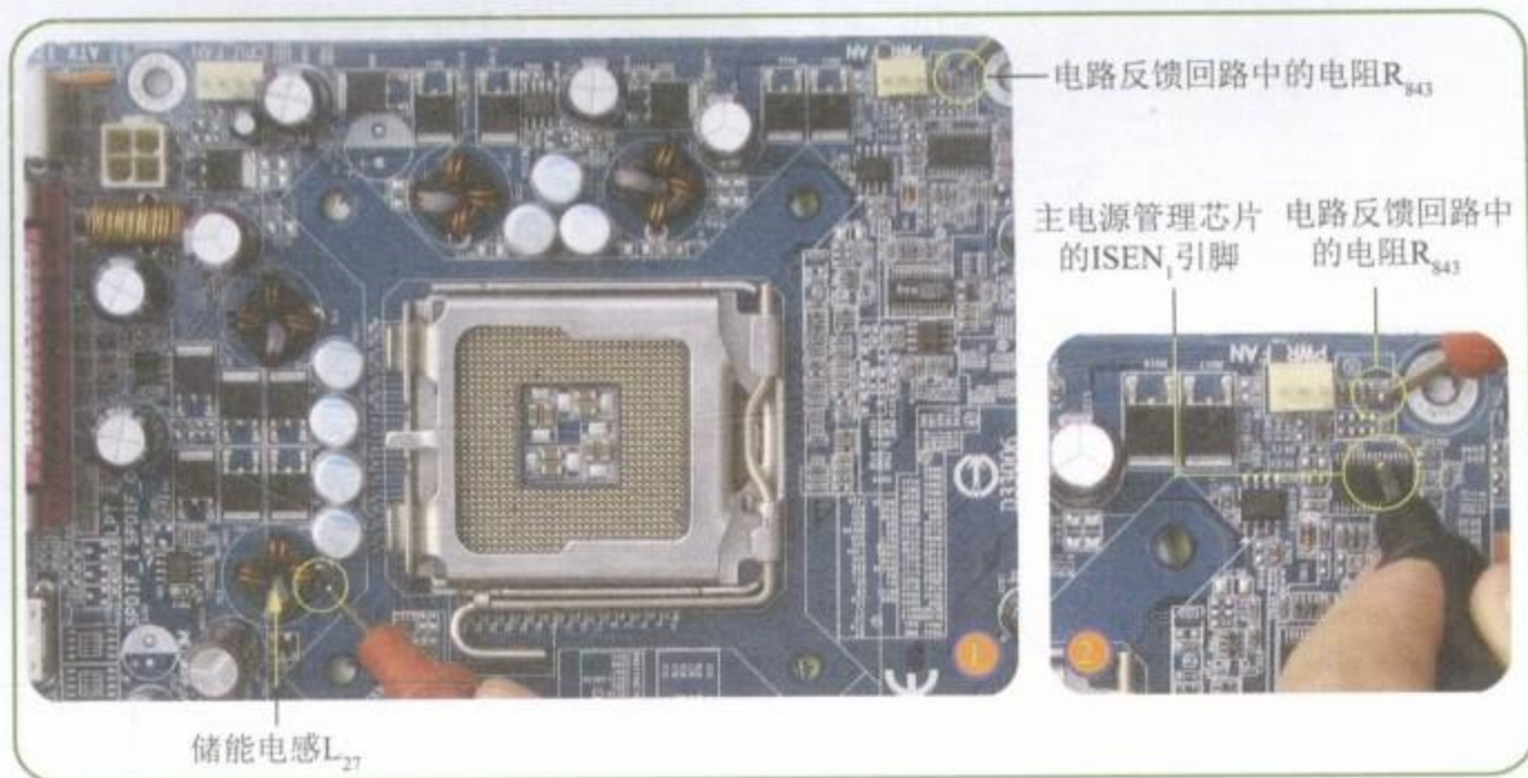
图8-61 电流反馈回路
