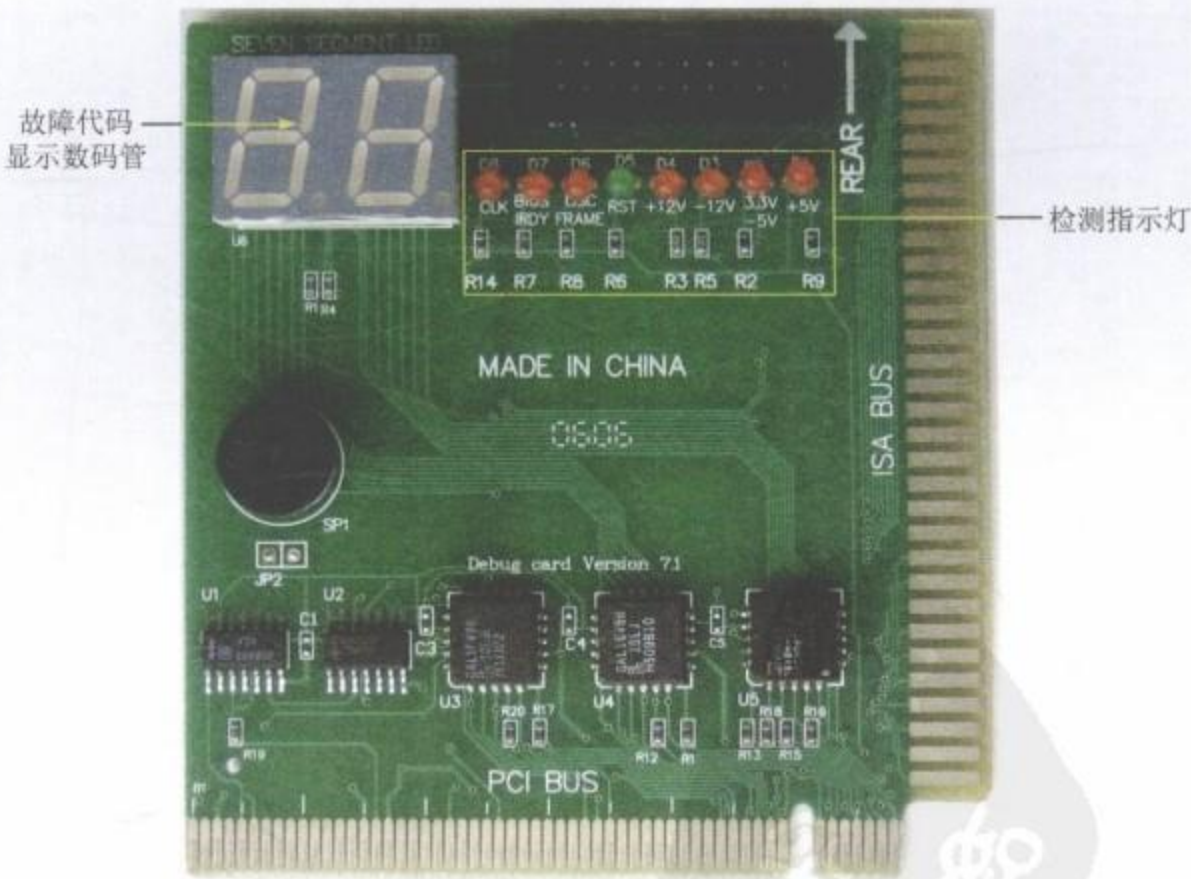
图2-8 故障诊断卡
