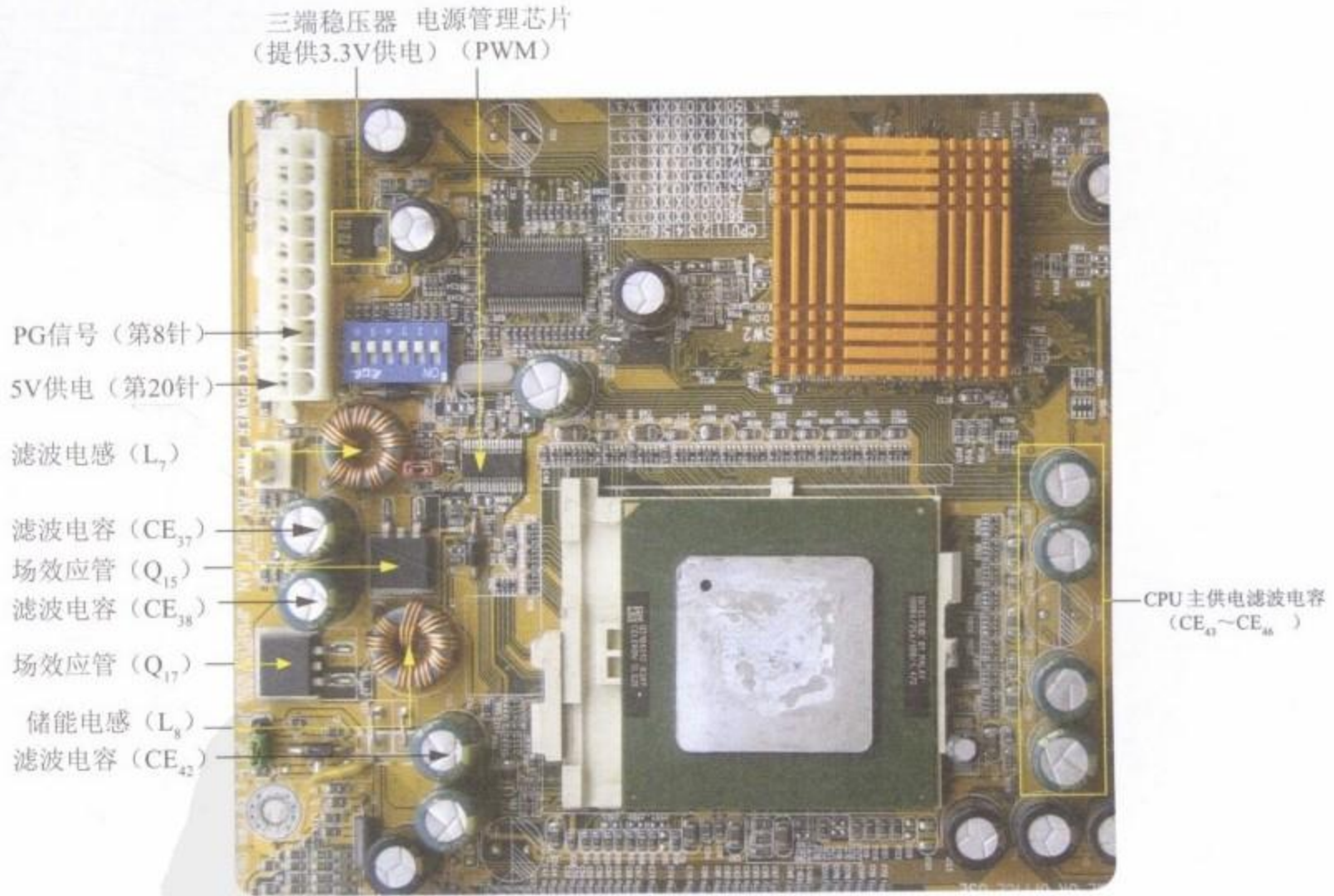
(b) CPU单相供电电路实物图
