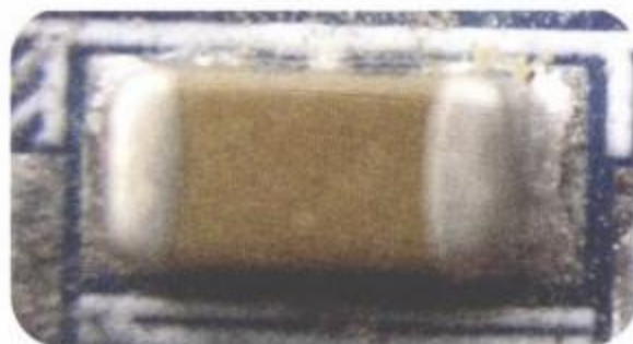
图2-29 陶瓷贴片电容器
