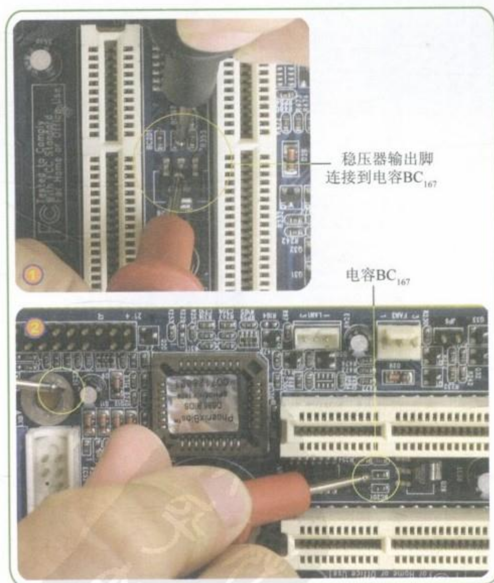
图6-25 测量Vout引脚连接滤波电容BC 167 的线路
