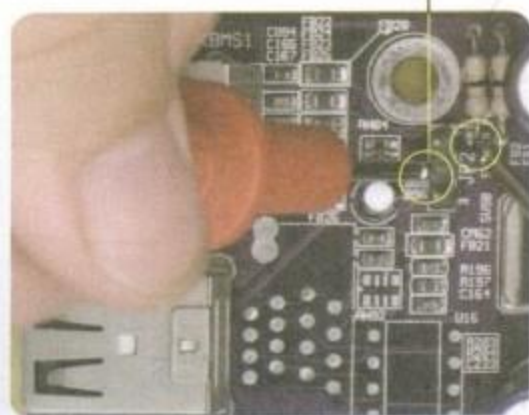
(b) 测量保险电阻到跳线的线路
