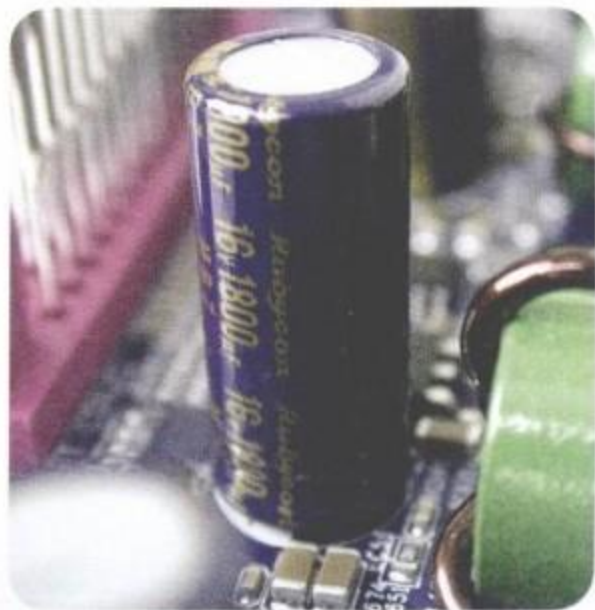
图2-27 主板铝电解电容器
