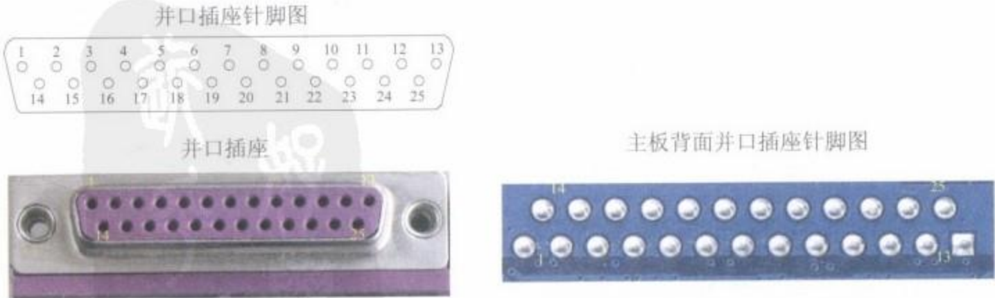
图5-10 并口各个针脚的排列顺序
