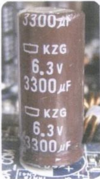
图8-6 供电电路中的电容
