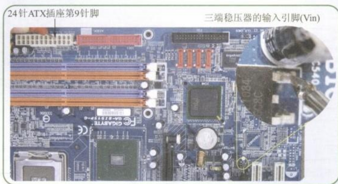
图7-14 测量电源插座第9脚与三端稳压器连接的线路
