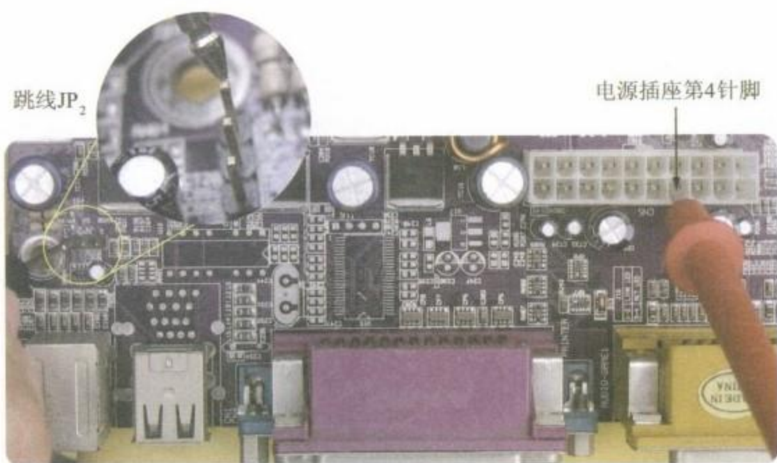
图5-33 测量电源插座到跳线JP 2 的线路
