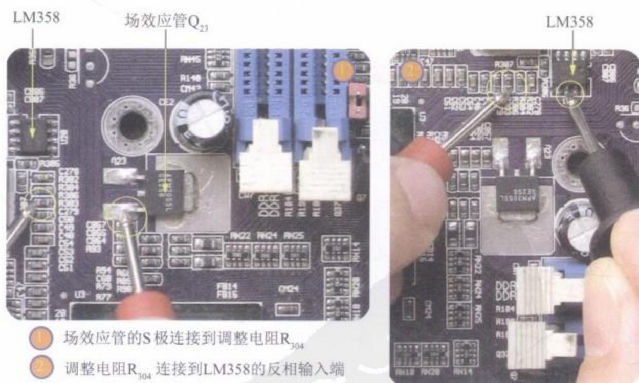
图8-67 测量场效应管 Q_{23} 的S极连接到LM358反相输入端的线路
