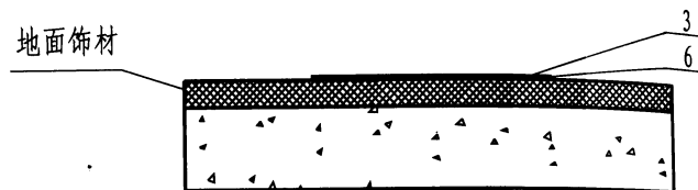
地面疏散标志安装图 IV（胶结安装）
