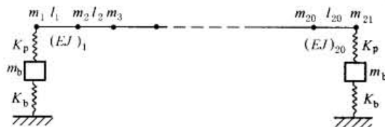
图 18-8-6 发电机转子模型
