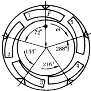
图 7-1-22 例 3 可倾瓦径向轴承的布置
