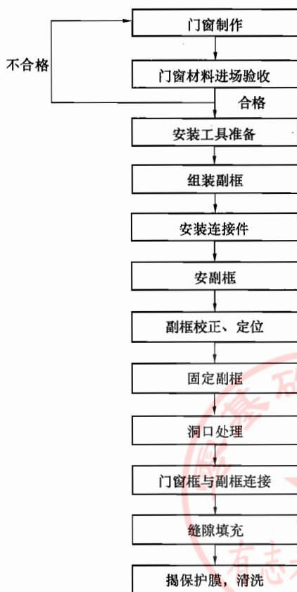
图 23-9 有副框彩板门窗安装工序
