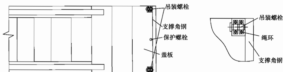
图 37-54 桁架吊装点
