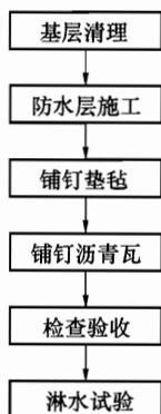
图 26-38 沥青瓦屋面施工工艺
