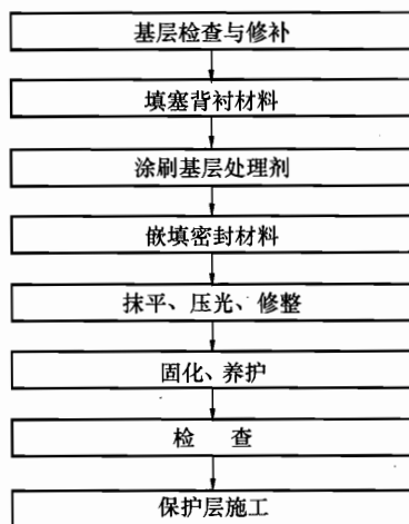
图 26-74 接缝密封防水施工工艺流程
