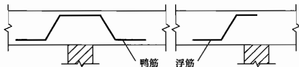
图 14-13 附加斜钢筋(鸭筋)的设置
