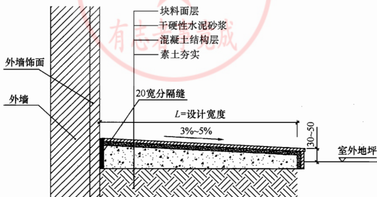
图 25-51 块料面层散水构造做法简图
