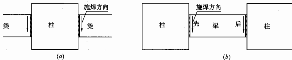
图 17-116 工字形梁的焊接顺序
