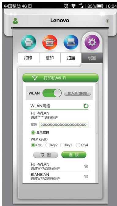
可以通过 WLAN 的开闭状态来设置 Wi-Fi 模块的开启和关闭。改变 Wi-Fi 状态时，必须重启打印才能生效。
