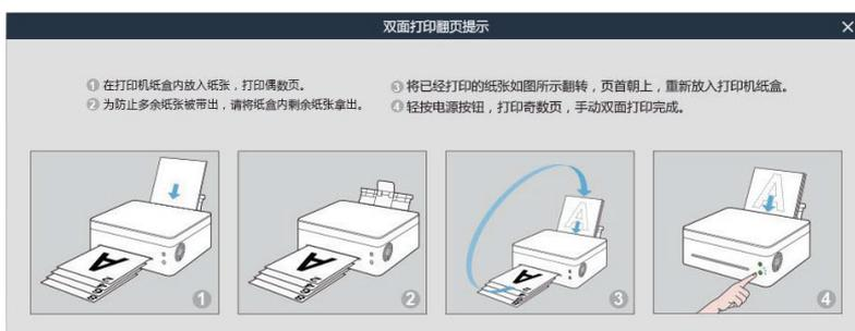
步骤 4：偶数页打印完毕后按照提示首先移除纸盒内剩余的纸，然后对打印页面进行翻页，按下打印机电源按钮进行奇数页打印；
