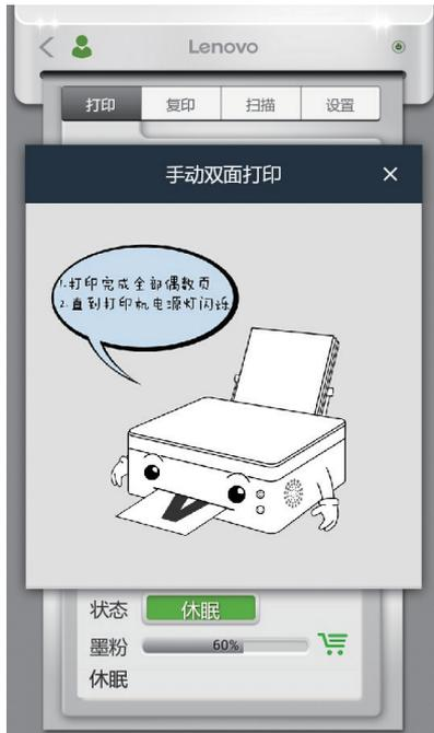
步骤 4：偶数页打印完毕后会出动画提示；请按照动画提示移除纸盒内剩余纸张并将已打印纸张翻转并放入纸盒，点击打印机电源按钮进行奇数页打印；
