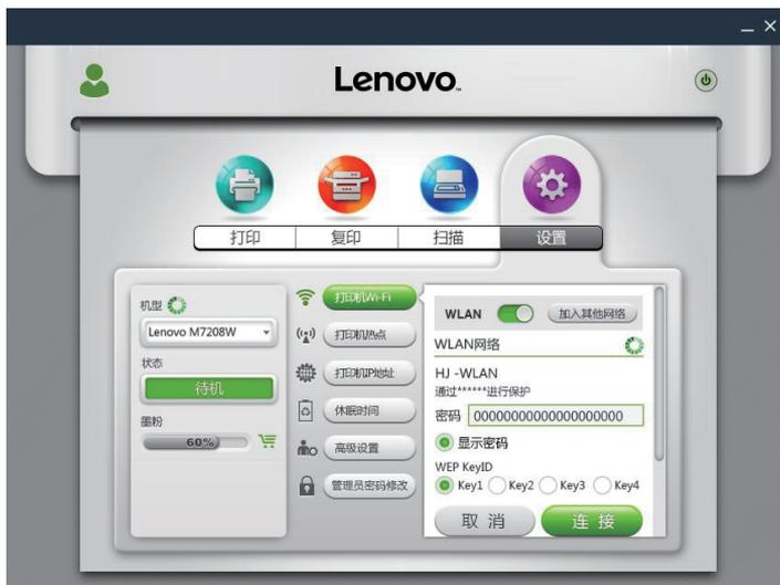
可以通过 WLAN 的开关状态来设置 Wi-Fi 模块的开启和关闭。改变 Wi-Fi 状态时，必须重启打印机才能生效。
