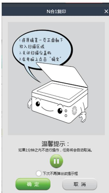
步骤 3：当第一页原稿复印后，打印机上 2 个绿色指示灯闪烁，请在 1 分钟之内按照弹出的动画提示放置后面的原稿，按打印机的开始按钮；循环本步骤，直至打印机吐纸；
