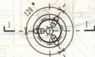
防冻给水栓安装图(一)零件详图
