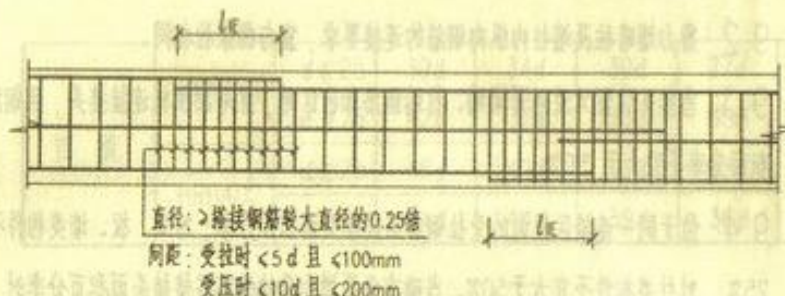
受力钢筋搭接长度范围内箍筋构造
