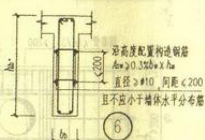
l_n/h_n < 2.5 时, 连梁截面构造
