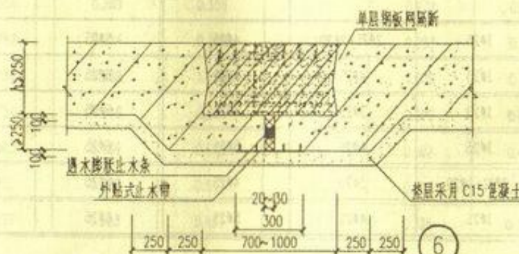
地下室底板后浇带超前止水构造
