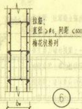
钢筋混凝土抗震墙构造
