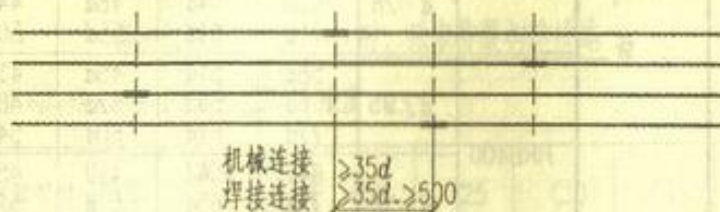
钢筋机械连接及焊接
