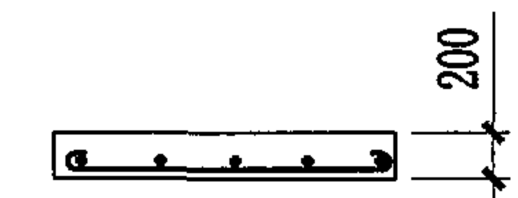
钢筋混凝土盖板剖面
